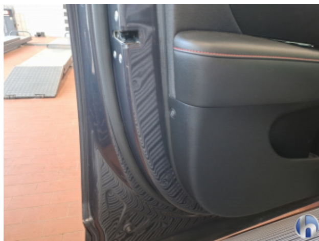
2. Tür Vorne - Links 3 Dellen - Sanft Instandsetzen
