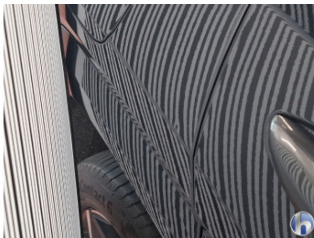
4. Seitenwand - Hinten - Rechts 1 Delle - Sanft Instandsetzen
