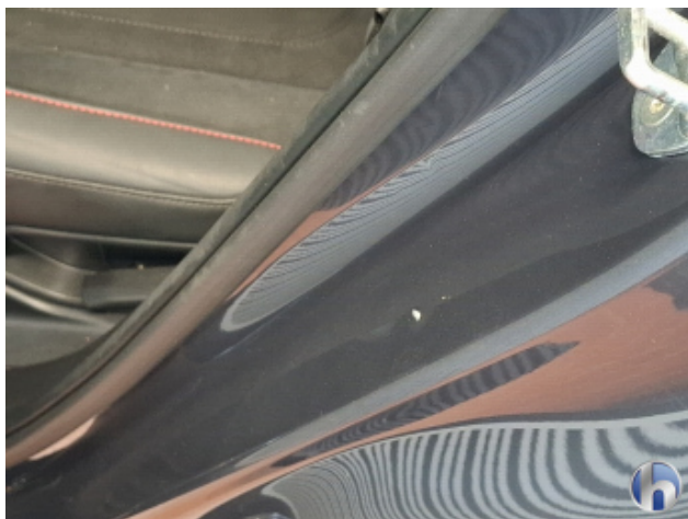
3. Türeinstieg Hinten - Links Delle Bis 20 Mm Mit Lackschaden - Smart Repair
