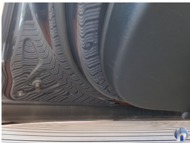
2. Tür Vorne - Links 3 Dellen - Sanft Instandsetzen
