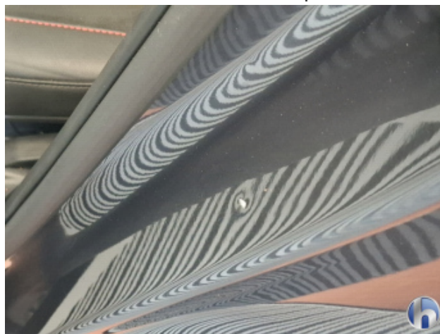
3. Türeinstieg Hinten - Links Delle Bis 20 Mm Mit Lackschaden - Smart Repair
