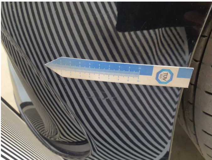
Damage 18: Front bumper: Front bumper (Zusätzlich Zierleiste re. Unten gebrochen) - Scratch(es) - Paint
