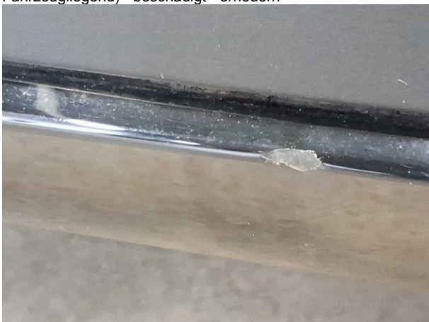
Beschädigung #4: Stossfänger hinten: Spoiler (Abrieb) - Kratze... erneuern
