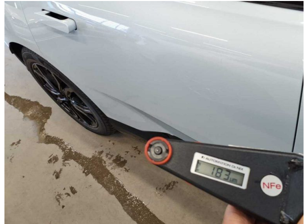
Nachlackierung 1: Seitenwand rechts, Tür hinten rechts
