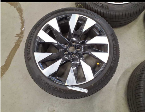
Damage #5: 2nd wheel set: 1 alloy rim (AbtriebsicherheitsrelevanteBeschädigung) - Scratched - Replace
