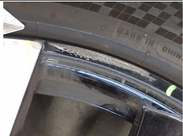
Beschädigung #5: 2.Radsatz: 1 Leichtmetallfelge (AbtriebsicherheitsrelevanteBeschädigung) - verkratzt /
