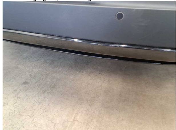
Beschädigung #4: Stossfänger hinten: Spoiler (Abrieb) - Kratzer - erneuern
