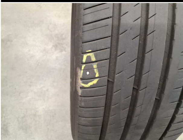
Beschädigung #3: 2.Radsatz: 1 Reifen (Nagel Lauffläche HR im Fahrzeugliegend) - beschädigt - erneuern
