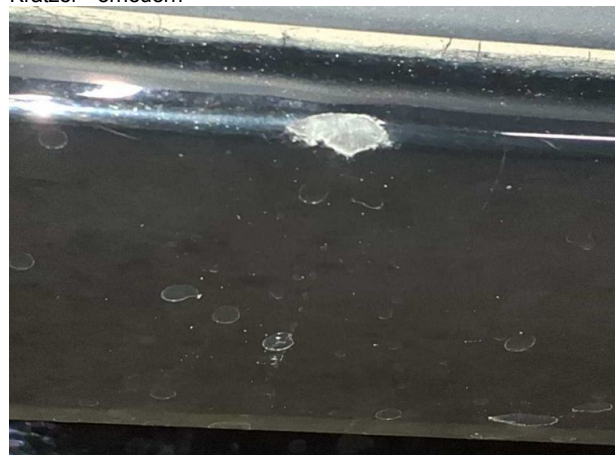
Beschädigung #4: Stossfänger hinten: Spoiler (Abrieb) - Kratzer - erneuern
