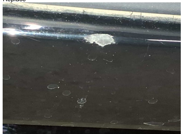
Damage #4: Rear bumper: Spoiler (Abrieb) - Scratch(es) - Replace
