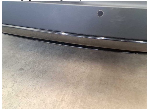
Damage #4: Rear bumper: Spoiler (Abrieb) - Scratch(es) - Replace
