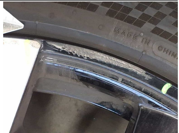
Damage #5: 2nd wheel set: 1 alloy rim (AbtriebsicherheitsrelevanteBeschädigung) - Scratched -
