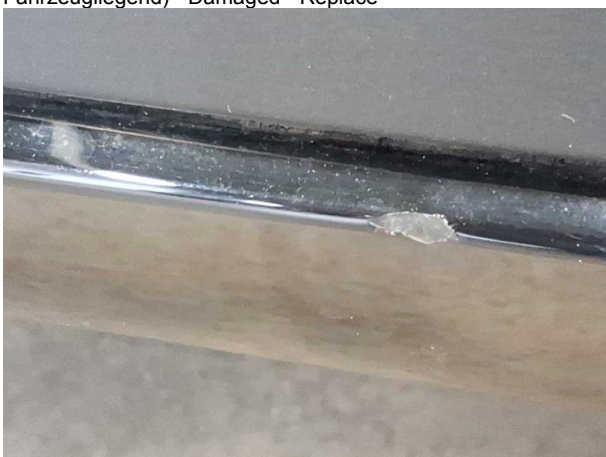
Damage #4: Rear bumper: Spoiler (Abrieb) - Scratch(es) - Replace
