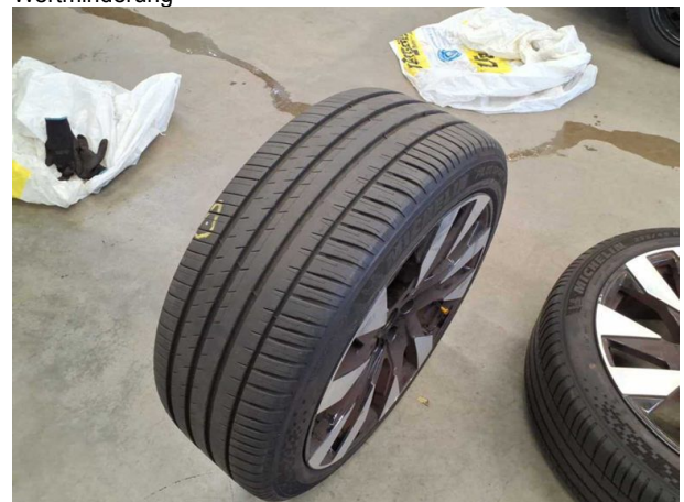
Beschädigung #3: 2.Radsatz: 1 Reifen (Nagel Lauffläche HR im Fahrzeugliegend) - beschädigt - erneuern
