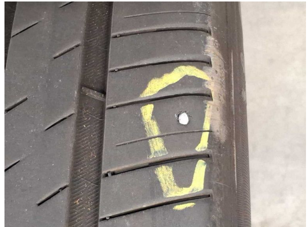
Damage #3: 2nd wheel set: 1 tyre (Nagel Lauffläche HR im Fahrzeugliegend) - Damaged - Replace
