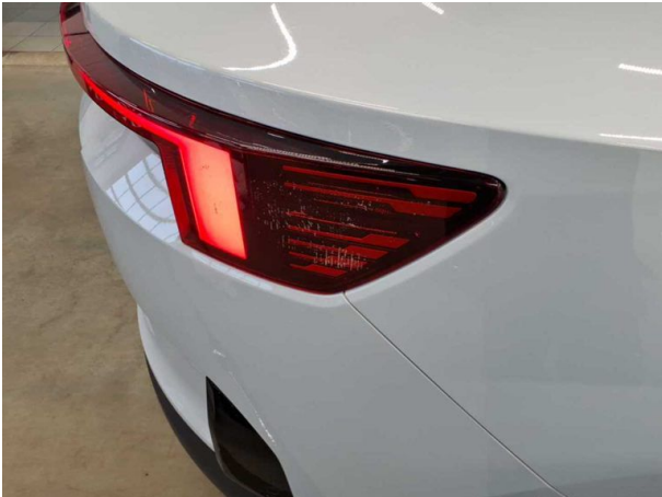
Beschädigung #1: Heckleuchte: Heckleuchte rechts (Klebereste) - beklebt/ beschriftet - reinigen
