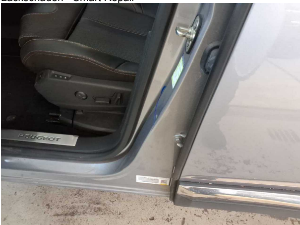
Beschädigung #4: Schweller links: Einstieg - Delle / Lackschade... Smart Repair
