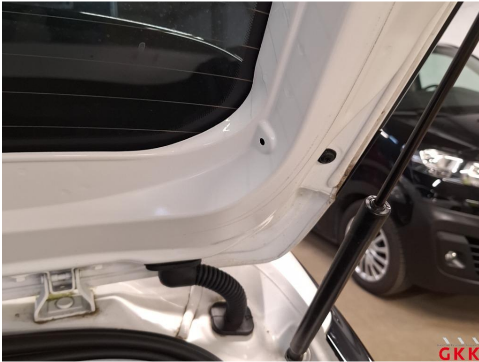
Bild 15 Laderaum, Abdeckung -Halteseil-, fehlt, ersetzen
