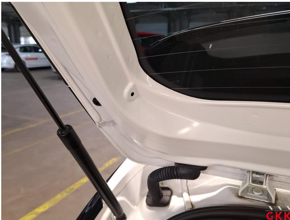
Bild 14 Laderaum, Abdeckung -Halteseil-, fehlt, ersetzen
