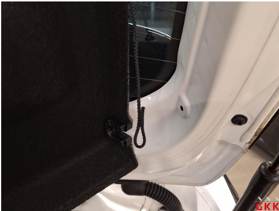
Bild 16 Laderaum, Abdeckung -Halteseil-, fehlt, ersetzen
