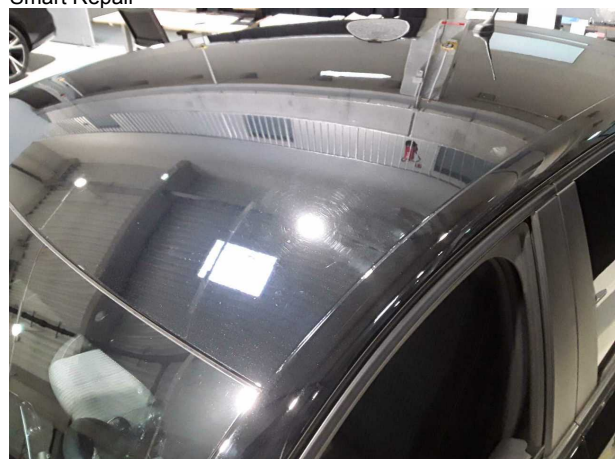
Beschädigung #8: Fahrzeugdach: Dach (Harzflecken - Folgekosten möglich) - Lackmangel - Smart Repair
