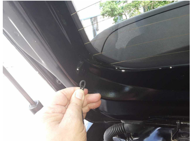
Beschädigung #3: Interieur: Hutablage (Gepäckraumabdeckung / Halterung fehlt) - Funktion /
