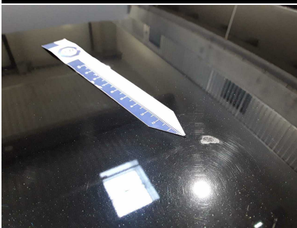
Beschädigung #8: Fahrzeugdach: Dach (Harzflecken - Folgekosten möglich) - Lackmangel - Smart Repair
