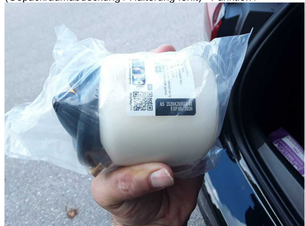
Beschädigung #4: Ausrüstung: Tirefit Füllmittel - abgelaufen - erneuern
