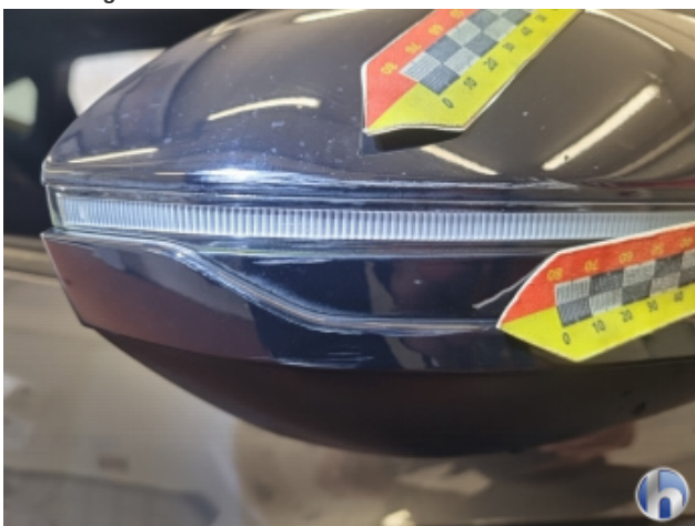
1. Außenspiegel Gehäuse - Rechts Beschädigt - Erneuern
