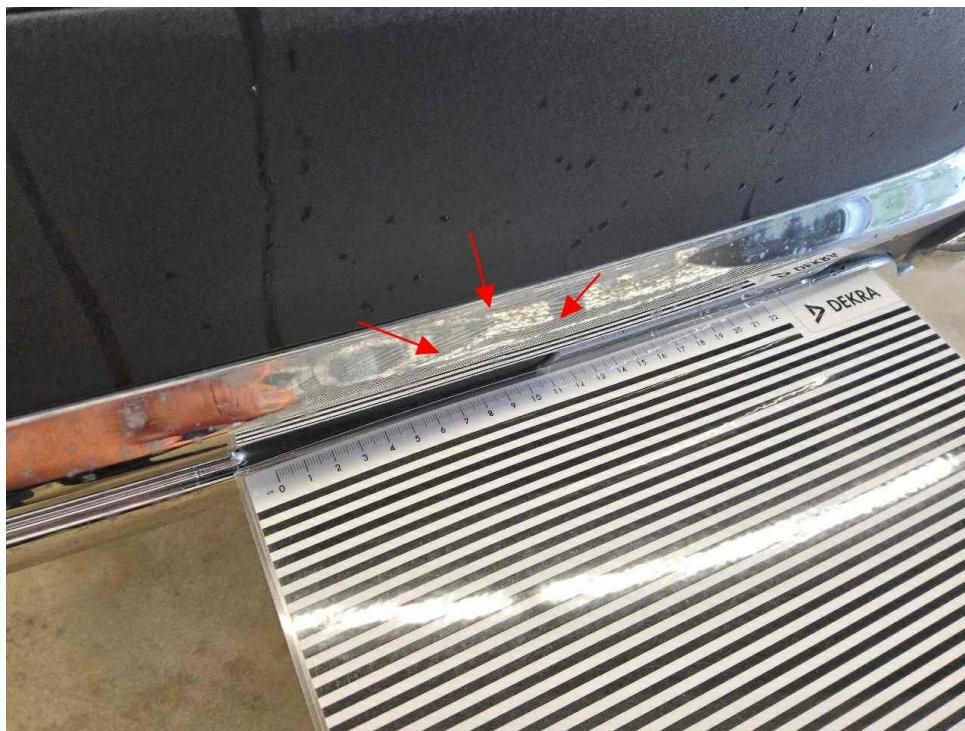
Bild 14 : Stoßfänger hinten Chromblende deformiert
