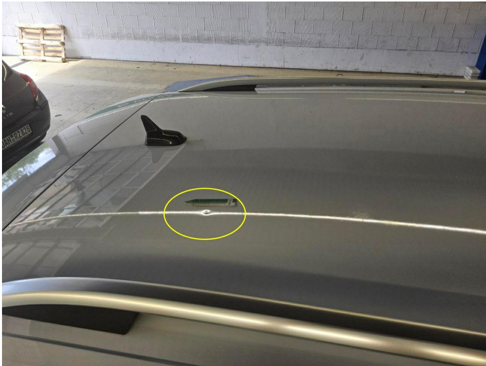
Bild 25 : Dach, eingedellt, drücken
