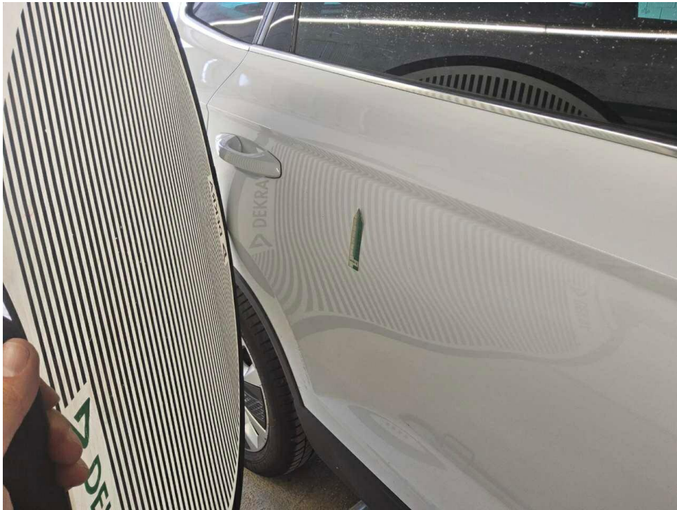
Bild 17 : Tür hinten rechts, eingedellt, Gebrauchsspur
