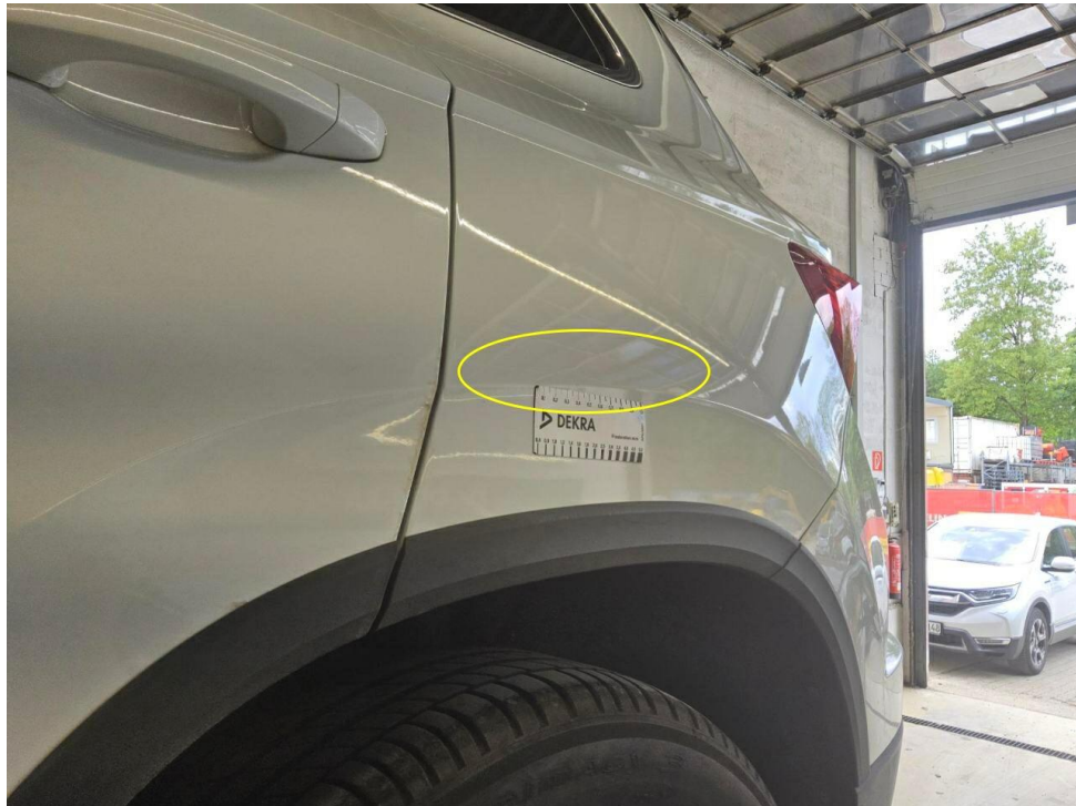
Bild 13 : Seitenteil hinten links Lackierung, zerkratzt, smart repair
