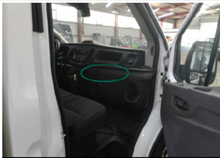
Armaturenbrett und Ablage / Vorne Rechts / Kratzer
