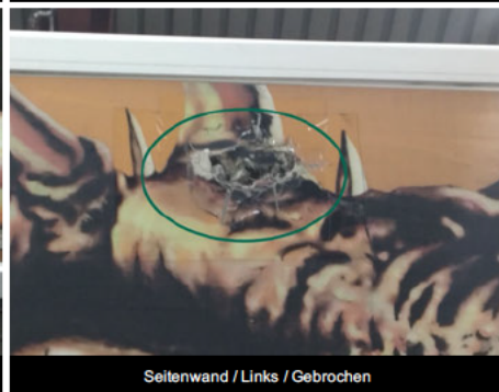
Seitenwand / Links / Gebrochen
