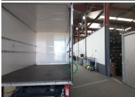
Dichtung Türeinstieg / Hinten Rechts / Gebrochen
