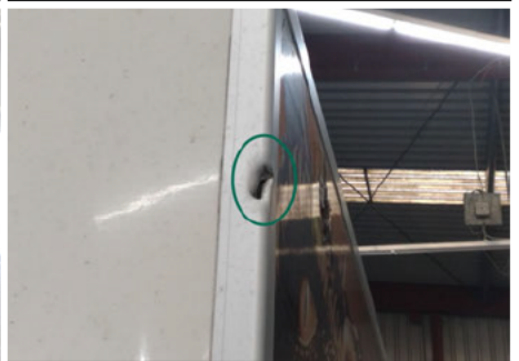
Seitenleiste / Mitte Vorne Links / Gebrochen
