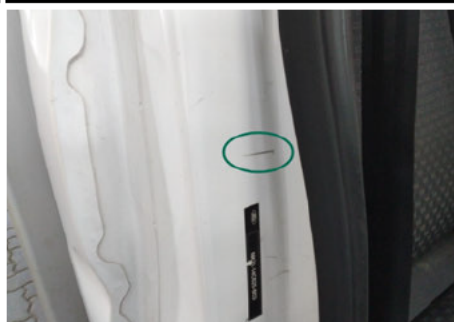
Säule / Vorne Rechts / Delle
