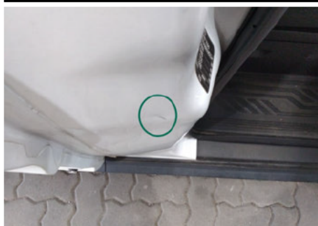
Säule / Vorne Rechts / Delle
