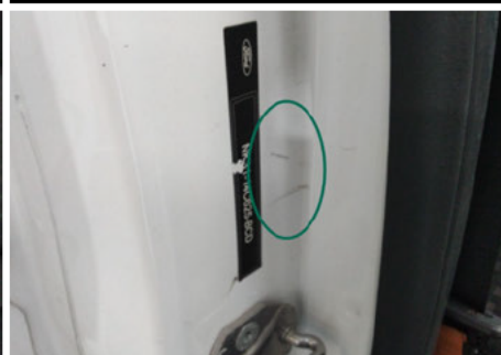
Säule / Vorne Rechts / Delle
