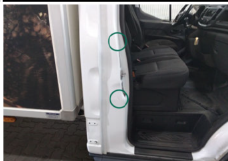
Säule / Vorne Rechts / Delle
