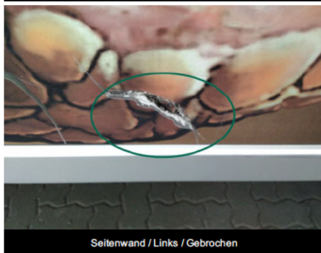
Seitenwand / Links / Gebrochen
