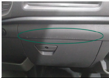
Armaturenbrett und Ablage / Vorne Rechts / Kratzer
