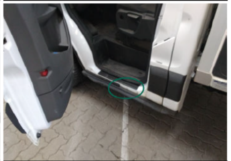
Dichtung Türeinstieg / Vorne Links / Gebrochen
