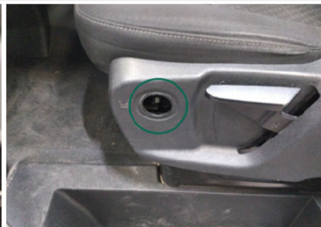
Hebel Sitzverstellung / Vorne Links / Fehlt
