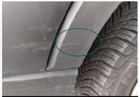
Kotflügelzuerleiste / Vorne Links / Kratzer
