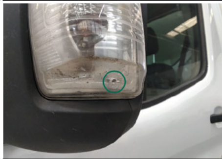
Blinker / Links / Gebrochen
