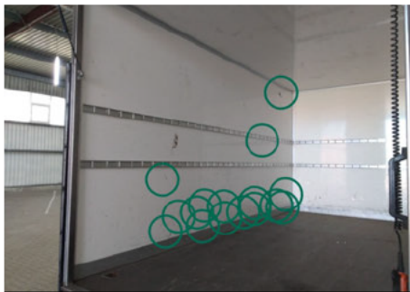
Seitenwand / Links / Gebrochen
