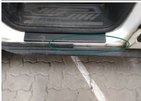
Dichtung Türeinstieg / Vorne Links / Gebrochen
