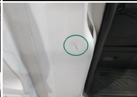
Säule / Vorne Rechts / Delle
