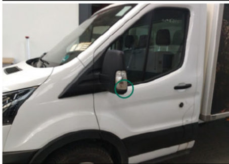
Blinker / Links / Gebrochen
