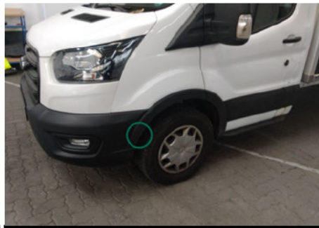
Kotflügelzuerleiste / Vorne Links / Kratzer
