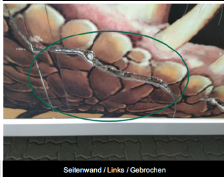
Seitenwand / Links / Gebrochen
