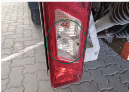
Heckleuchte / Hinten Links / Gebrochen
