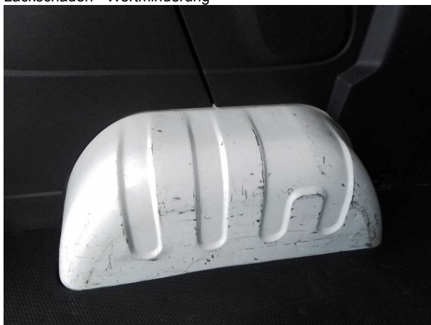
Beschädigung #8: Interieur: Innenraum (Laderaum) - Delle / Lackschaden - Wertminderung
