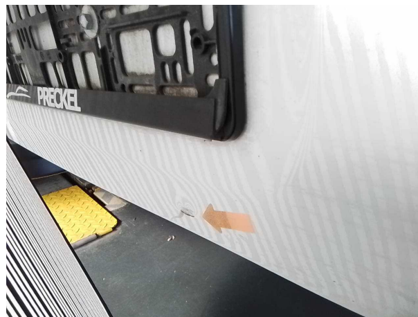
Beschädigung #12: Heckklappe/-tür: Hecktür links - verformt - instandsetzen und lackieren
