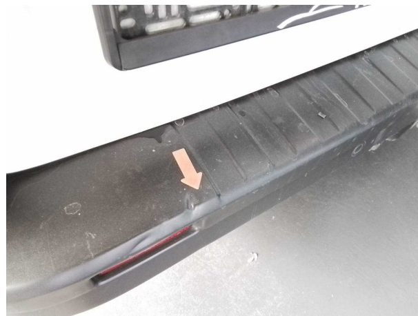
Beschädigung #10: Stossfänger hinten: Stossfänger hinten (unlackiert) - verformt - erneuern
