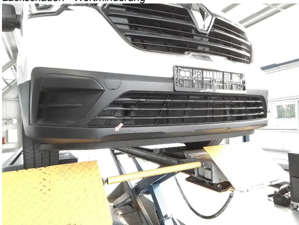
Beschädigung #9: Stossfänger vorn: Stossfänger vorn (unlackiert) - verformt - Wertminderung
