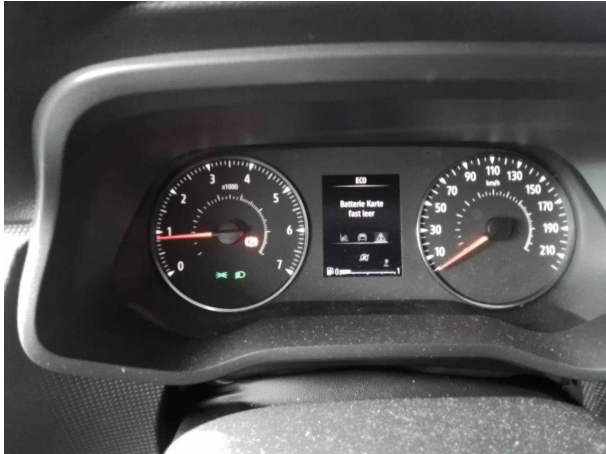
Beschädigung #1: Ausrüstung: Fahrzeugschlüssel (Batterie) - leer - erneuern
