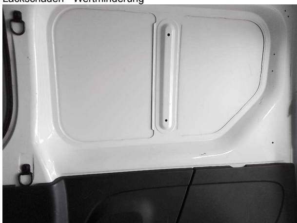
Beschädigung #8: Interieur: Innenraum (Laderaum) - Delle / Lackschaden - Wertminderung
