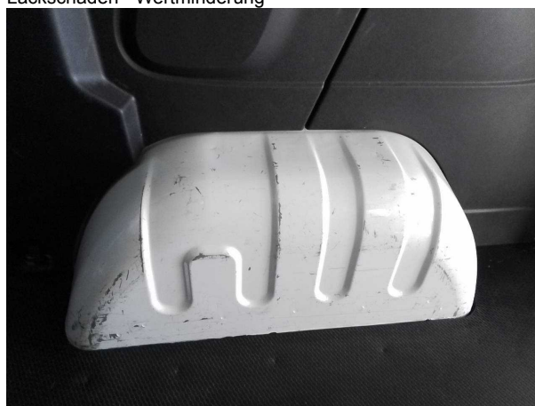
Beschädigung #8: Interieur: Innenraum (Laderaum) - Delle / Lackschaden - Wertminderung
