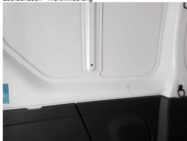
Beschädigung #8: Interieur: Innenraum (Laderaum) - Delle / Lackschaden - Wertminderung
