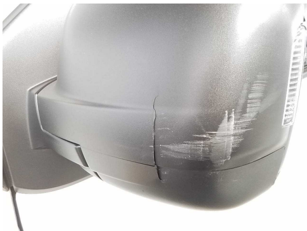
Beschädigung #5: Außenspiegel links: Abdeckkappe (Schaden-/Kostenausweitung nach Demontage möglich) - gebrochen / gerissen -
