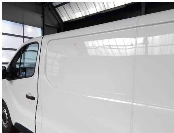
Beschädigung #6: Seitenwand links: Seitenwand - Delle(n) - sanft instandsetzen
