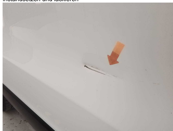
Beschädigung #13: Schiebetür rechts: Schiebetür - verformt - instandsetzen und lackieren
