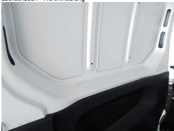
Beschädigung #8: Interieur: Innenraum (Laderaum) - Delle / Lackschaden - Wertminderung
