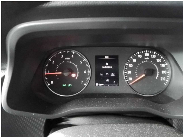
Beschädigung #3: Motor: Motor (Öl nachfüllen laut Bordcomputer - Folgekosten möglich) - leer - durchführen
