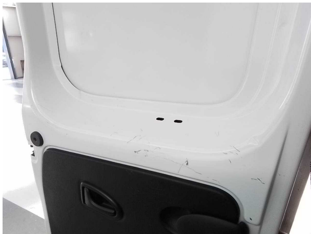
Beschädigung #8: Interieur: Innenraum (Laderaum) - Delle / Lackschaden - Wertminderung
