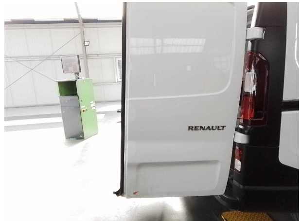
Beschädigung #4: Heckklappe/-tür: Hecktür rechts - Delle(n) - sanft instandsetzen
