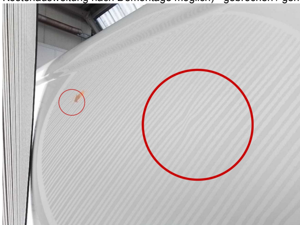
Beschädigung #6: Seitenwand links: Seitenwand - Delle(n) - sanft instandsetzen
