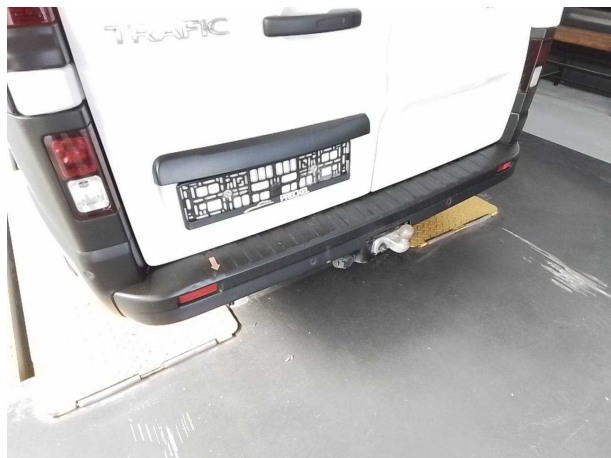
Beschädigung #10: Stossfänger hinten: Stossfänger hinten (unlacki... - verformt - erneuern
