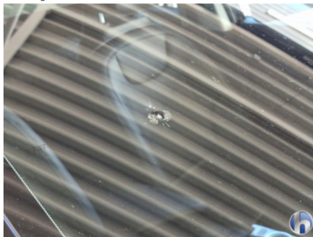
1. Windschutzscheibe Riss - Erneuern
