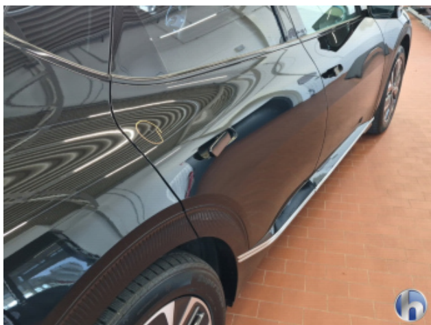
4. Tür Hinten - Rechts Lackabplatzer - Smart Repair
