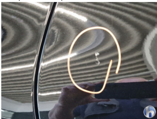
4. Tür Hinten - Rechts Lackabplatzer - Smart Repair
