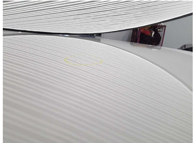
Beschädigung #4: Karosserie: Karosserie - Hagelschaden - instandsetzen
