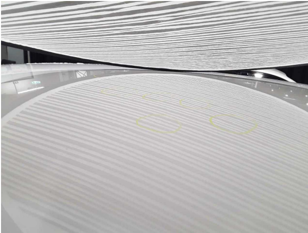
Beschädigung #4: Karosserie: Karosserie - Hagelschaden - instandsetzen
