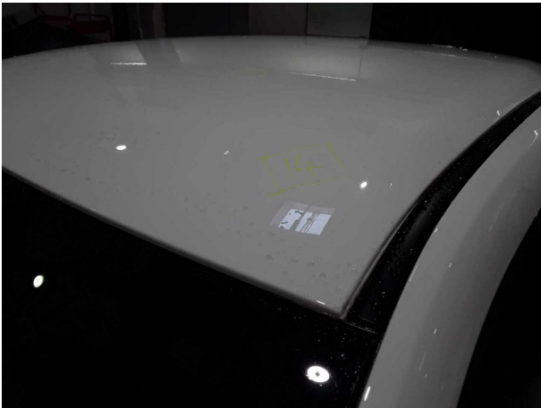
Beschädigung #4: Karosserie: Karosserie - Hagelschaden - instandsetzen
