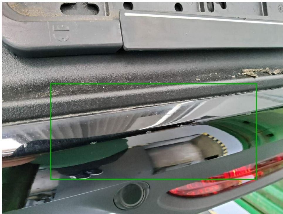
Bild 15 : Stoßfänger hinten Zierleiste, verschrammt
