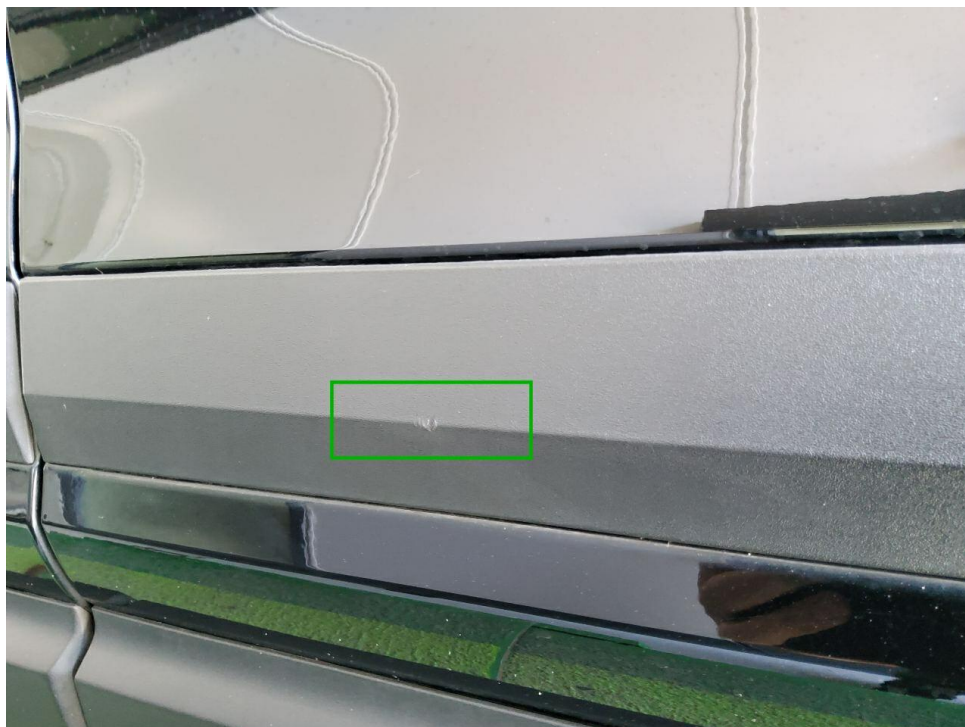
Bild 16 : Tür vorne rechts Zierleiste, verschrammt
