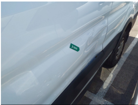
Panel lateral / Delantero Izquierdo / Abolladura
