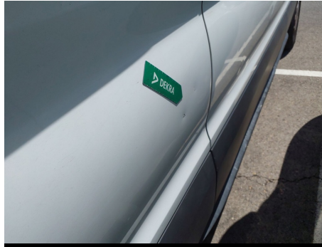
Panel lateral / Trasero Derecho / Abolladura
