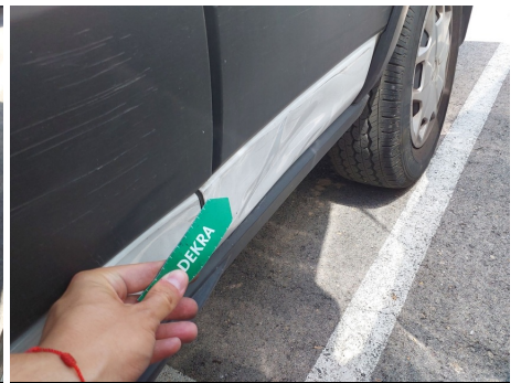
Panel lateral / Trasero Izquierdo / Abolladura
