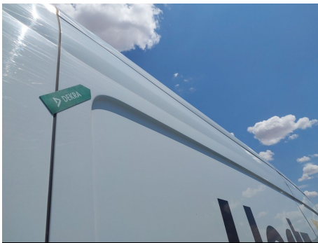
Panel lateral / Trasero Derecho / Abolladura
