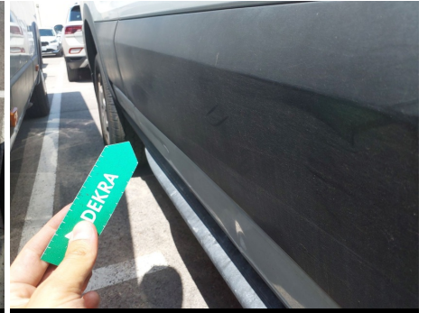
Panel lateral / Trasero Derecho / Abolladura
