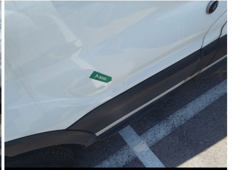
Puerta / Delantero Izquierdo / Abolladura
