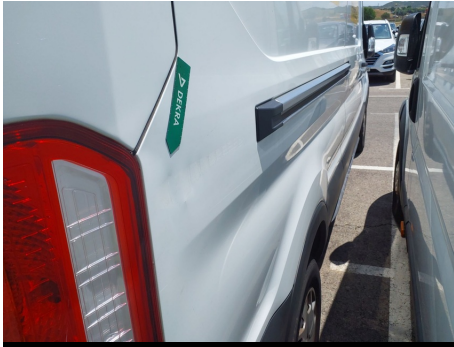
Panel lateral / Trasero Derecho / Abolladura
