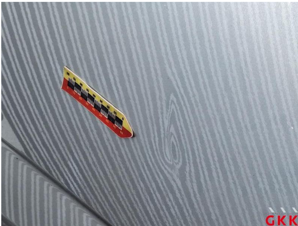
Bild 22. Tür vorne rechts, beschädigt, instand setzen - lackieren
