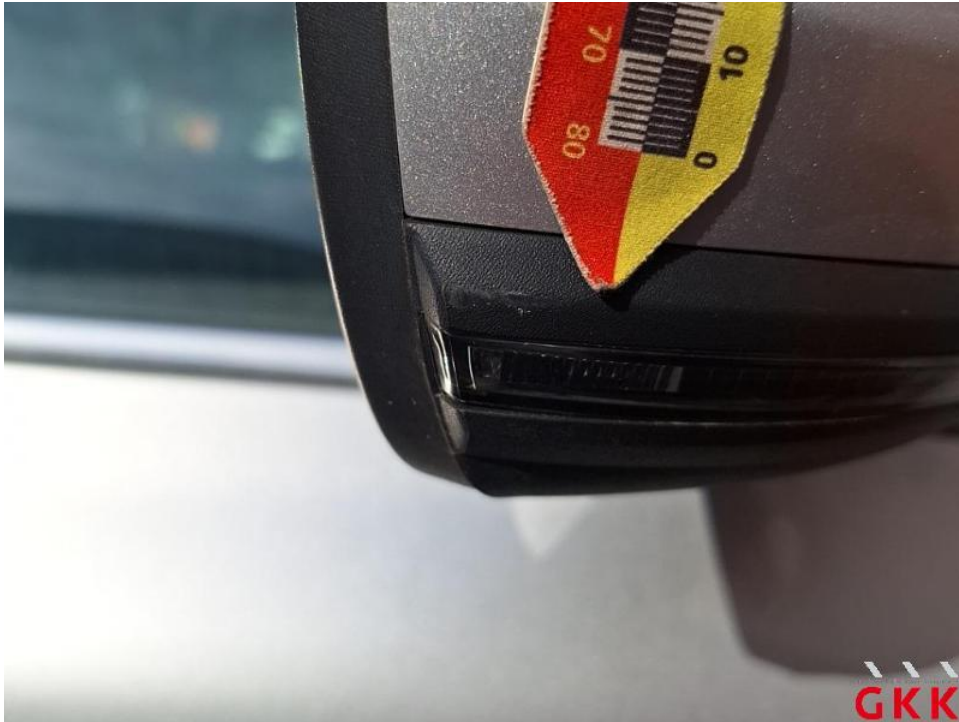
Bild 19. Spiegelgehäuse rechts, Blende -unlackiert-, verkratzt, ersetzen
