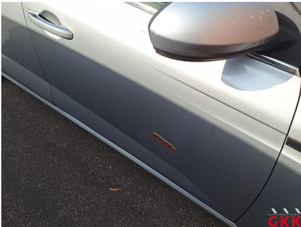
Bild 20. Tür vorne rechts, beschädigt, instand setzen - lackieren
