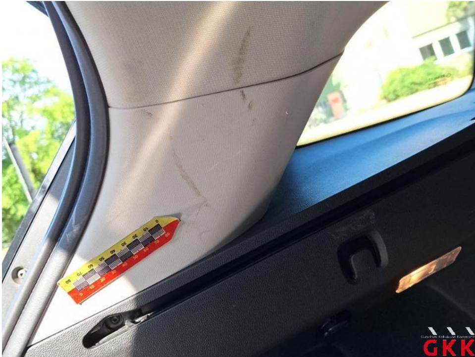
Bild 41. D- Säule links, Innenverkleidung, verkratzt, ersetzen
