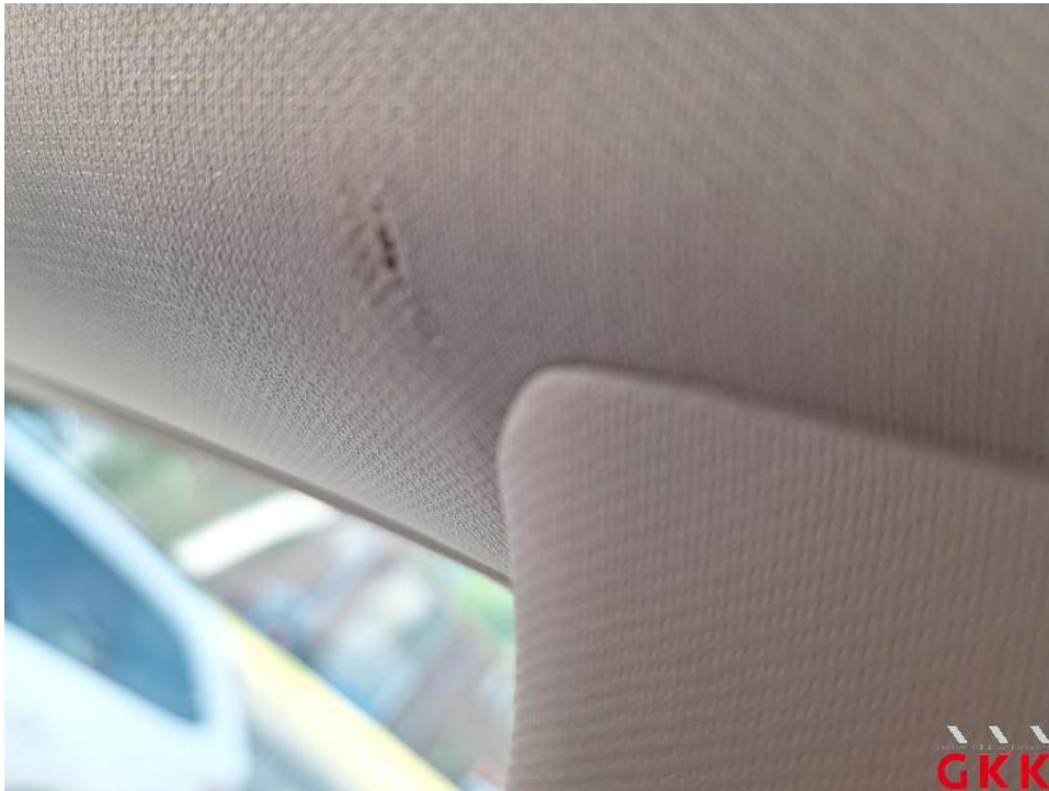
Bild 48. Himmel, beschädigt, ersetzen
