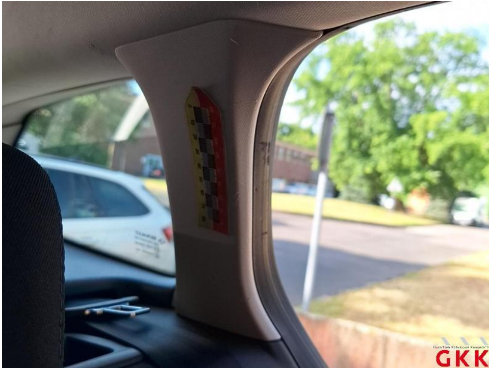
Bild 49. C- Säule links, Innenverkleidung, beschädigt, ersetzen
