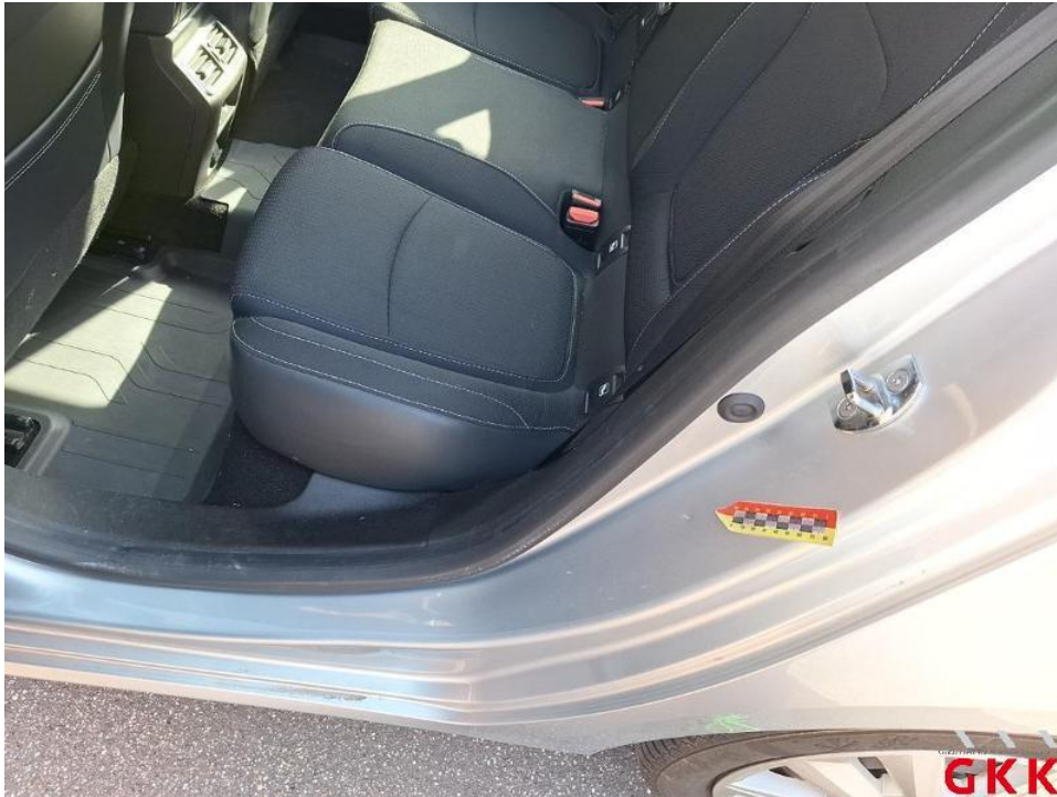
Bild 51. Tür hinten links, Einstieg, beschädigt, Smartrepair
