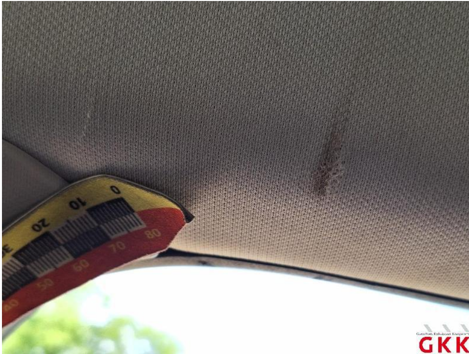
Bild 47. Himmel, beschädigt, ersetzen
