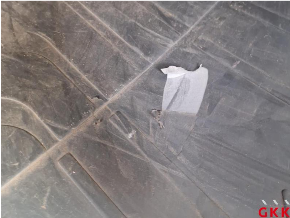
Bild 61. Fußmatte(n), vorne links, beschädigt, ersetzen
