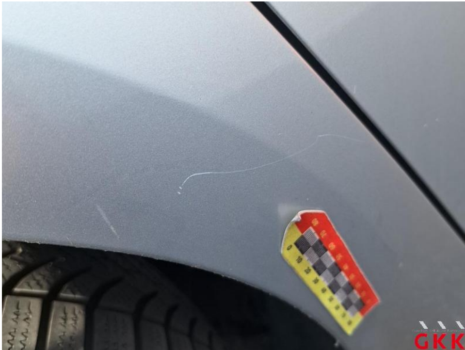
Bild 36. Seitenwand rechts, verkratzt, lackieren
