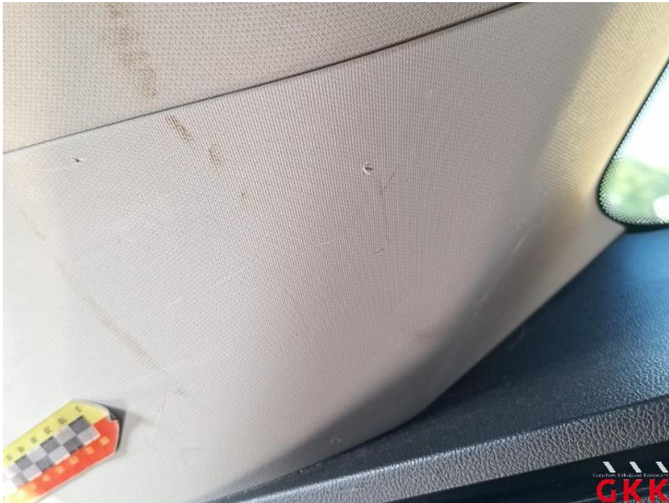
Bild 42. D- Säule links, Innenverkleidung, verkratzt, ersetzen
