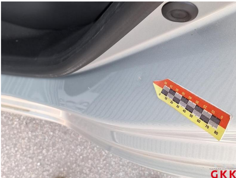
Bild 52. Tür hinten links, Einstieg, beschädigt, Smartrepair
