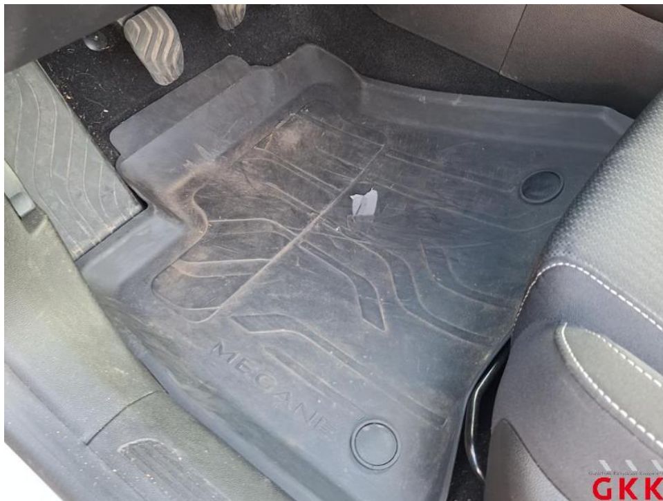
Bild 60. Fußmatte(n), vorne links, beschädigt, ersetzen
