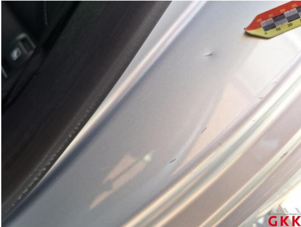
Bild 53. Tür hinten links, Einstieg, beschädigt, Smartrepair
