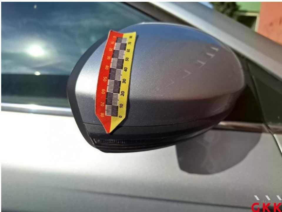
Bild 18. Spiegelgehäuse rechts, Blende -unlackiert-, verkratzt, ersetzen
