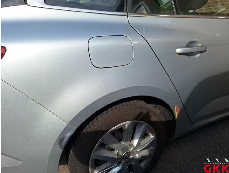
Bild 35. Seitenwand rechts, verkratzt, lackieren
