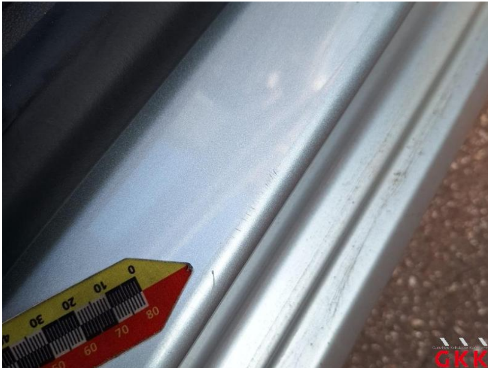
Bild 26. Tür vorne rechts, Einstieg, verkratzt, Smartrepair
