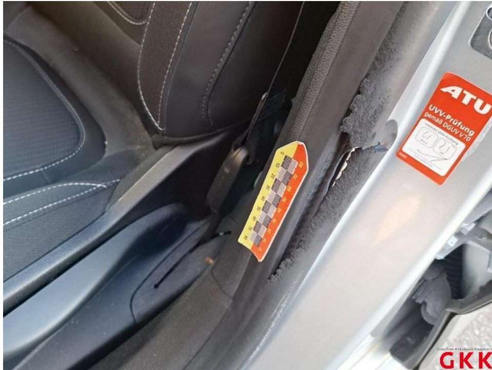
Bild 59. Tür vorne links, Dichtung -Einstieg-, beschädigt, ersetzen
