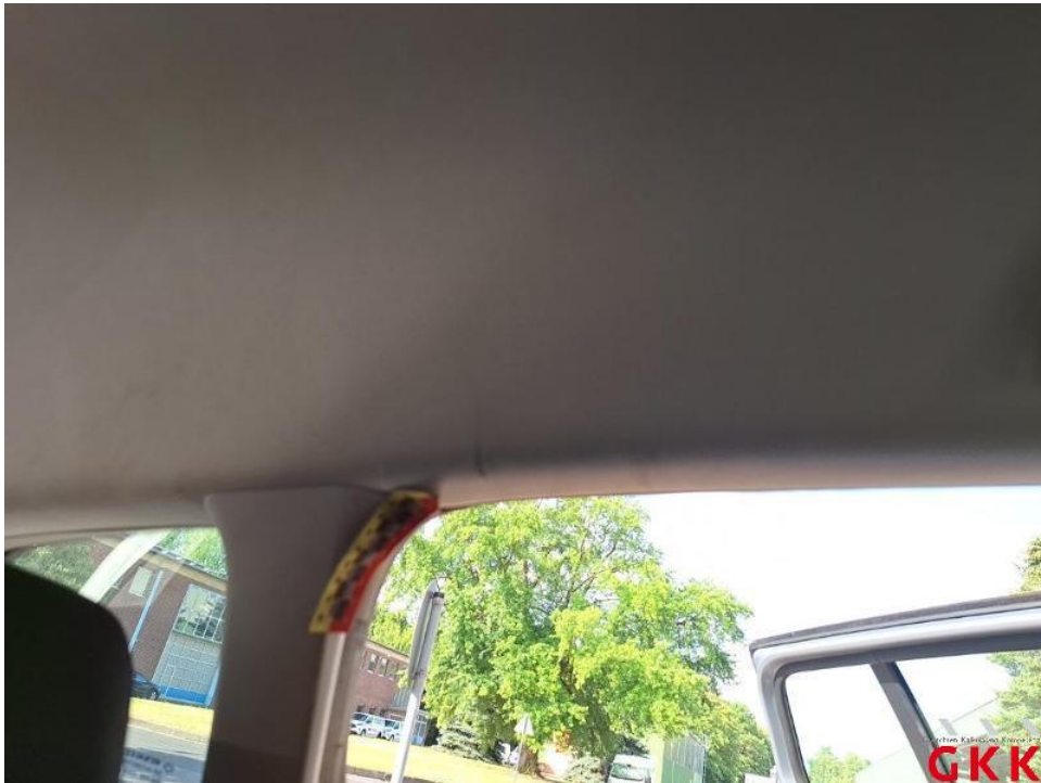
Bild 46. Himmel, beschädigt, ersetzen
