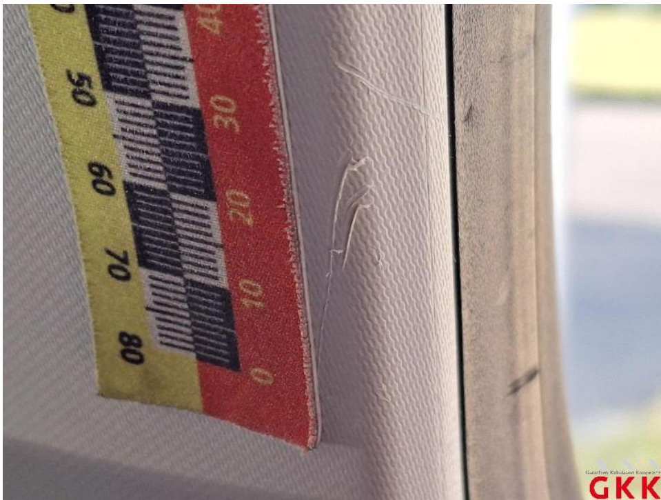
Bild 50. C- Säule links, Innenverkleidung, beschädigt, ersetzen
