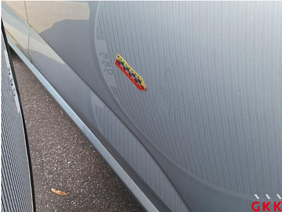
Bild 21. Tür vorne rechts, beschädigt, instand setzen - lackieren
