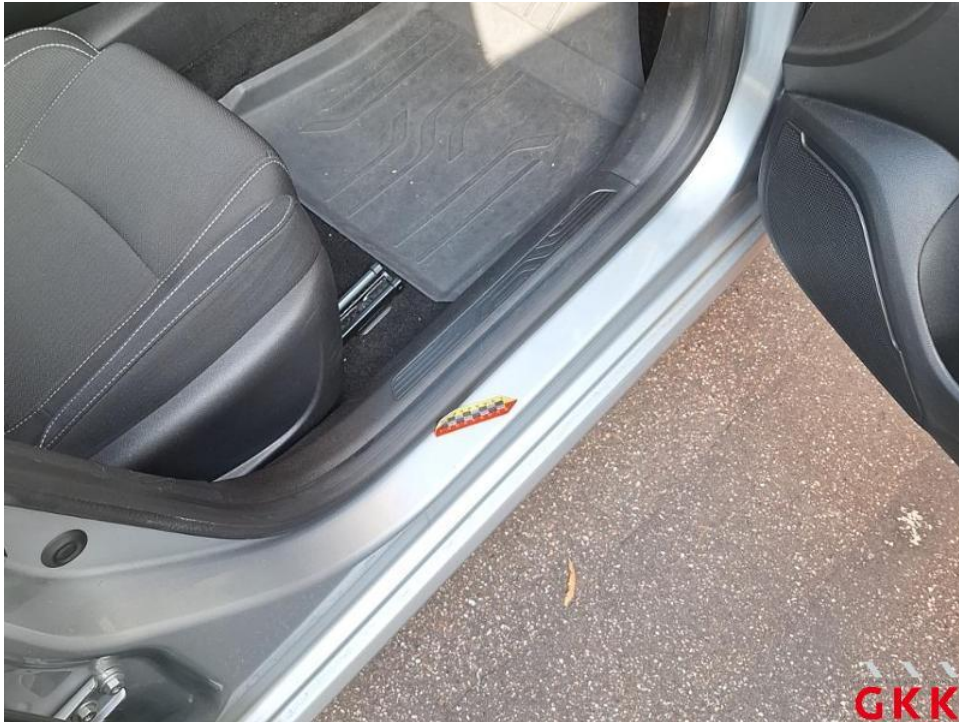
Bild 25. Tür vorne rechts, Einstieg, verkratzt, Smartrepair
