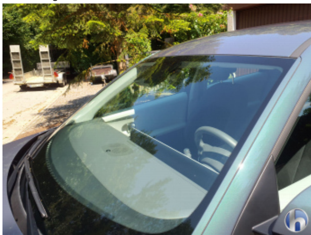
7. Windschutzscheibe Steinschlag Im Sichtfeld - Erneuern
