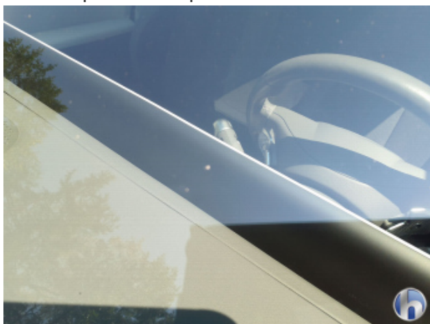
7. Windschutzscheibe Steinschlag Im Sichtfeld - Erneuern
