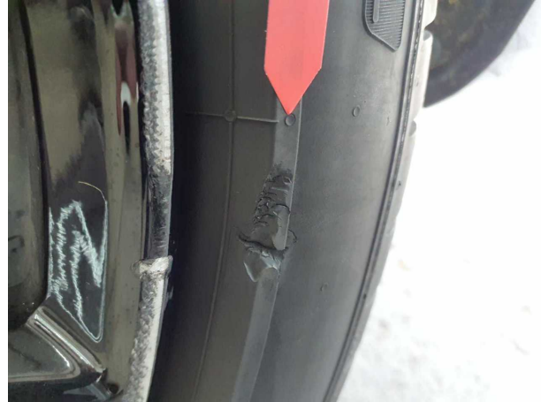
Beschädigung #6: Rad/Reifen: Reifen hinten links - beschädigt - erneuern
