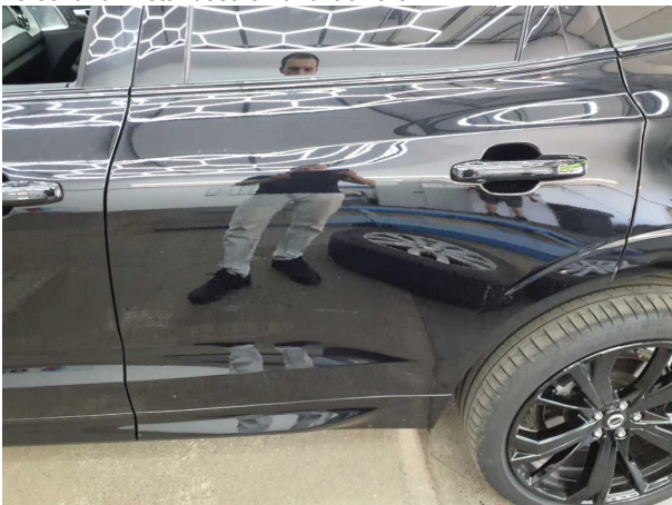
Beschädigung #12: Tür hinten links: Tür - nicht fachgerecht instandgesetzt - instandsetzen und lackieren
