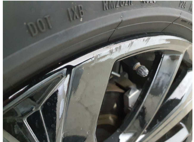
Beschädigung #10: Rad/Reifen: Leichtmetallfelge vorn rechts - Kratzer - erneuern
