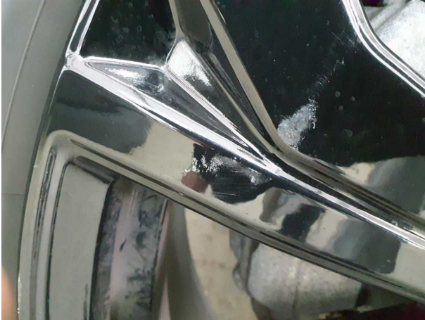
Beschädigung #9: Rad/Reifen: Leichtmetallfelge vorn links - verkratzt / verschürft - erneuern
