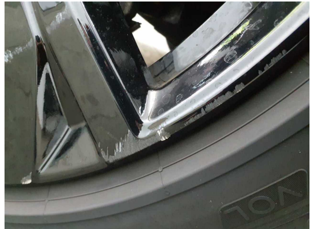
Beschädigung #10: Rad/Reifen: Leichtmetallfelge vorn rechts - Kratzer - erneuern
