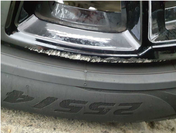
Beschädigung #10: Rad/Reifen: Leichtmetallfelge vorn rechts - Krat... - erneuern
