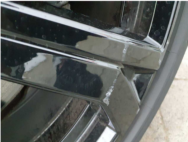
Beschädigung #10: Rad/Reifen: Leichtmetallfelge vorn rechts - Kratzer - erneuern
