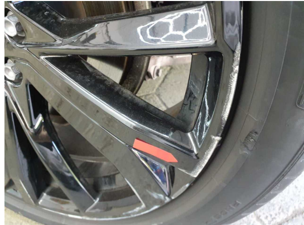
Beschädigung #7: Rad/Reifen: Leichtmetallfelge hinten links - Kratzer - erneuern
