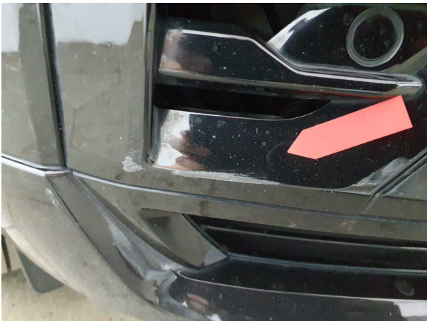
Beschädigung #11: Stossfänger vorn: Lufteinlassgitter - verkratzt / verschürft - instandsetzen und lackieren
