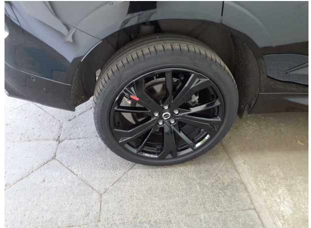
Beschädigung #8: Rad/Reifen: Leichtmetallfelge hinten rechts - Kratzer - erneuern
