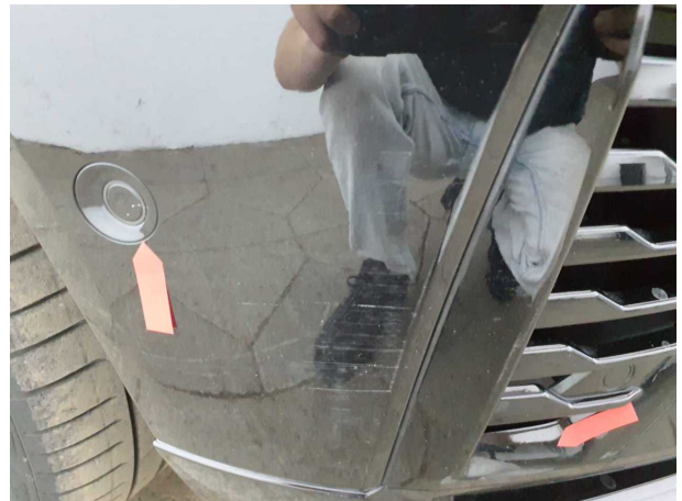
Beschädigung #14: Stossfänger vorn: Stossfänger mit Parktronic... verkratzt / verschürft - instandsetzen und lackieren
