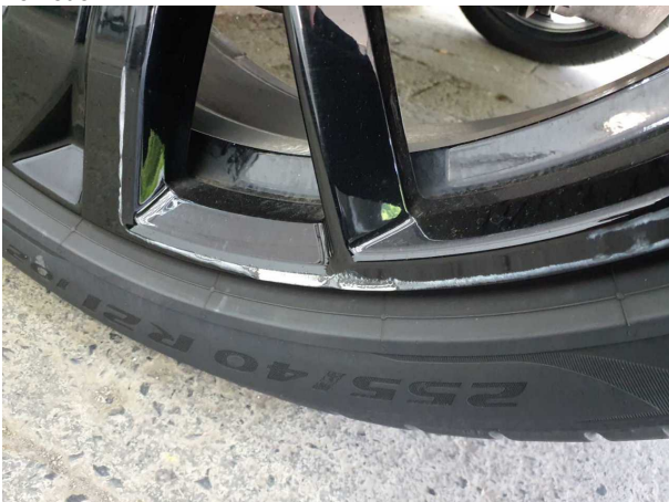
Beschädigung #7: Rad/Reifen: Leichtmetallfelge hinten links - Kratzer - erneuern
