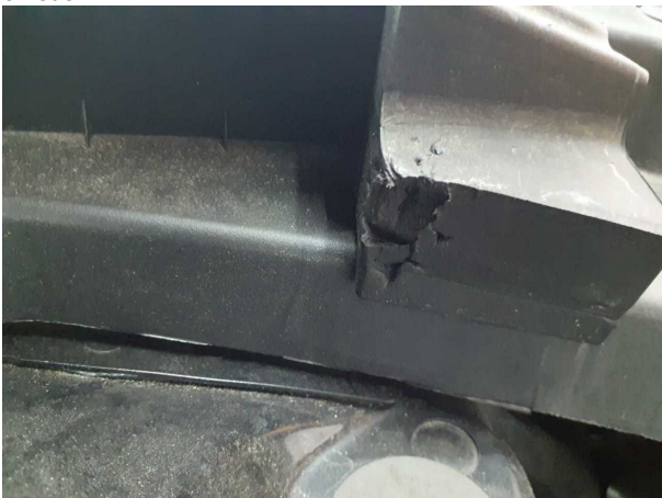
Beschädigung #2: Motor: Motorabdeckung (Füllstoff) - beschädigt - erneuern
