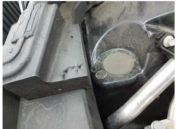
Beschädigung #2: Motor: Motorabdeckung (Füllstoff) - beschädigt - erneuern
