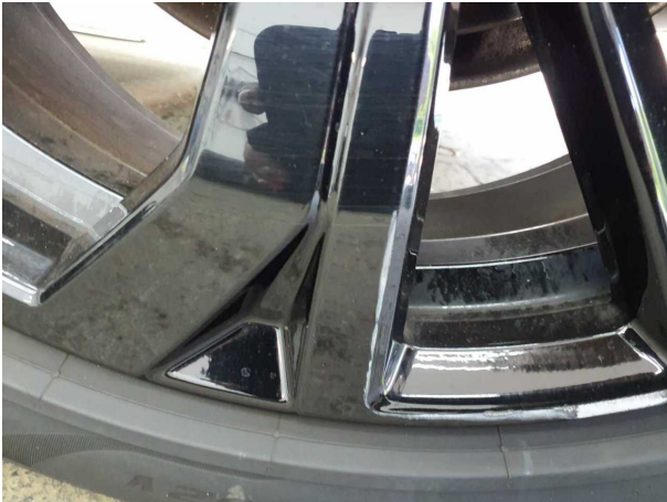
Beschädigung #7: Rad/Reifen: Leichtmetallfelge hinten links - Kratzer - erneuern
