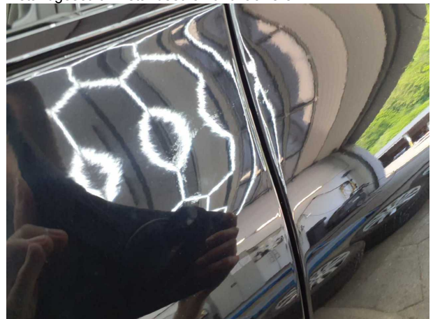
Beschädigung #13: Tür vorn links: Tür - nicht fachgerecht instandgesetzt - instandsetzen und lackieren
