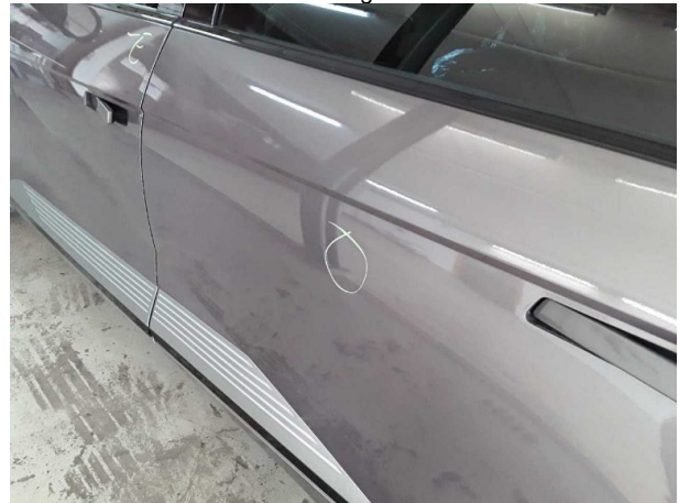
Beschädigung #6: Tür hinten links: Tür - Delle(n) - sanft instandsetzen
