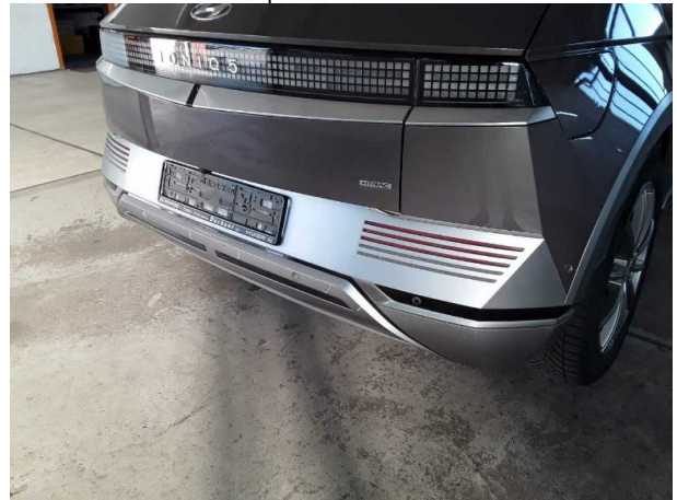
Beschädigung #9: Stossfänger hinten: Spoiler - verkratzt / verschürft - instandsetzen und lackieren
