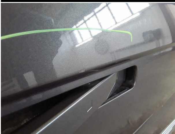
Beschädigung #7: Tür vorn rechts: Tür - verkratzt / verschürft - Smart Repair
