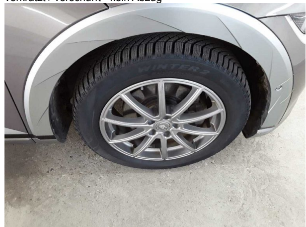
Beschädigung #4: Rad/Reifen: Leichtmetallfelge vorn rechts - verkratzt / verschürft - kein Abzug
