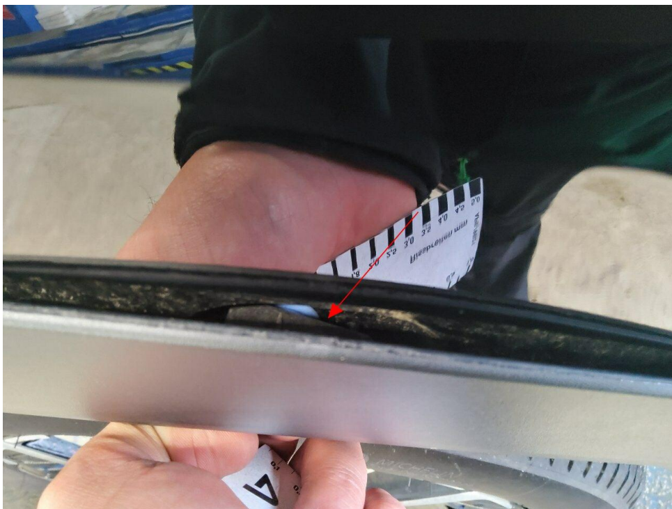
Bild 16 : Radlaufblende hinten links, Halter gebrochen
