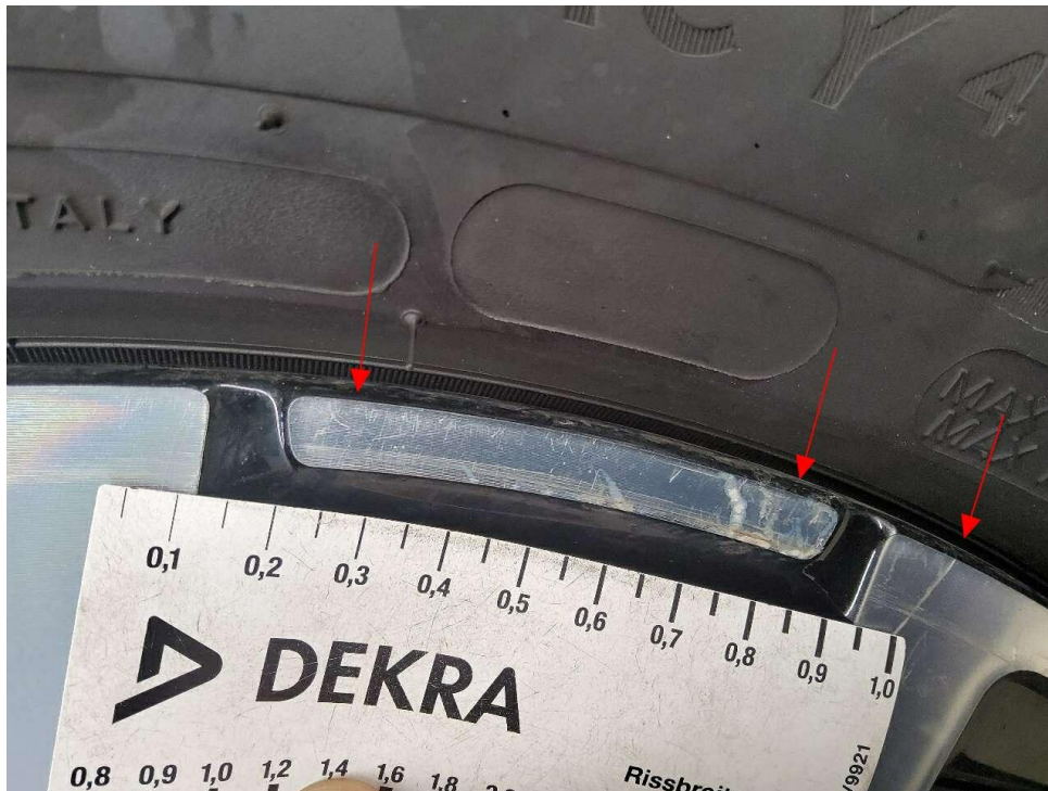
Bild 19 : LM-Felge hinten rechts, glanzgedreht, verschrammt, korridiert
