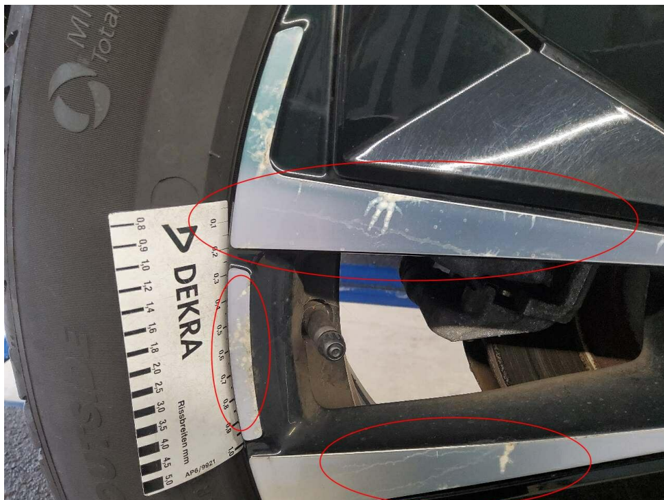
Bild 22 : LM-Felge hinten rechts, glanzgedreht, verschrammt, korridiert
