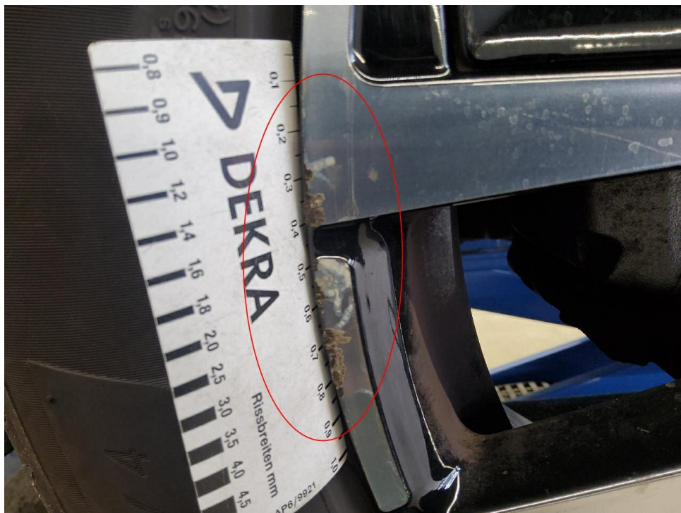
Bild 26 : LM-Felge vorne links, glanzgedreht, verschrammt
