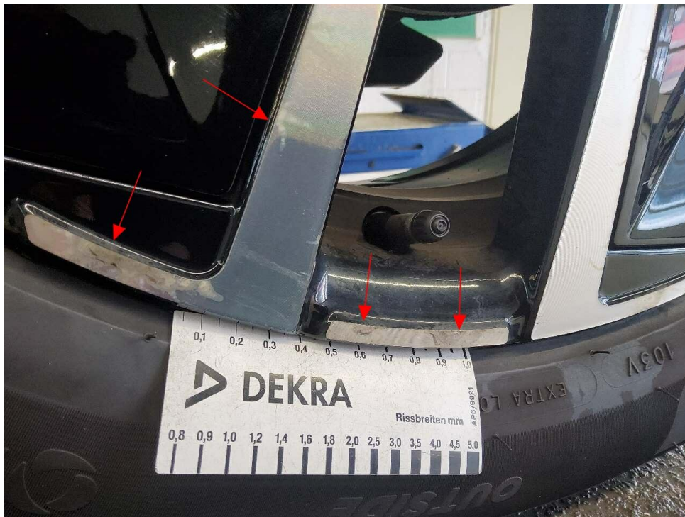
Bild 23 : LM-Felge hinten links, korridiert
