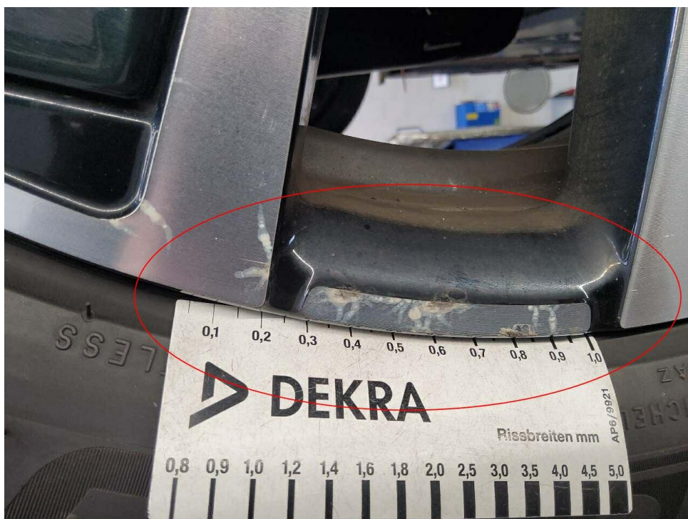
Bild 20 : LM-Felge hinten rechts, glanzgedreht, verschrammt, korridiert
