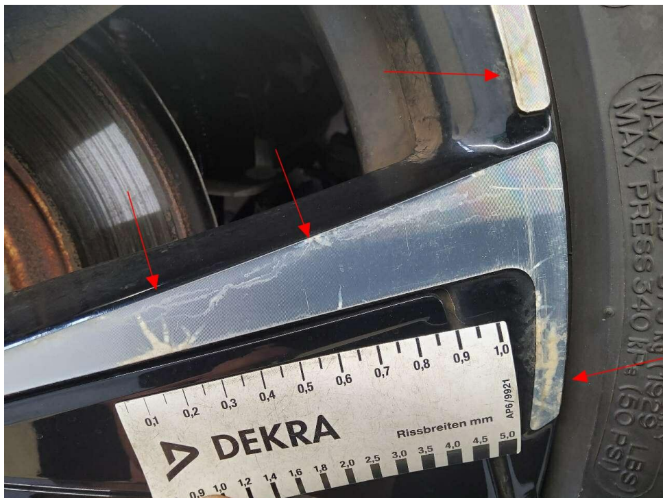
Bild 18 : LM-Felge hinten rechts, glanzgedreht, verschrammt, korrodiert
