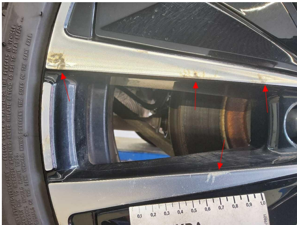
Bild 24 : LM-Felge hinten links, korridiert
