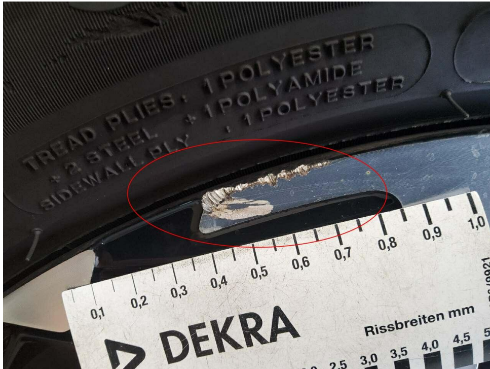
Bild 27 : LM-Felge vorne links, glanzgedreht, verschrammt
