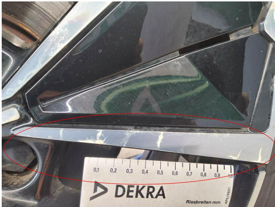
Bild 21 : LM-Felge hinten rechts, glanzgedreht, verschrammt, korridiert
