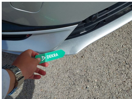
Paragolpes / Delantero / Abolladura
