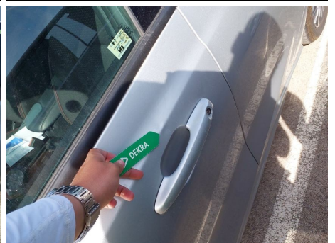
Puerta / Delantero Izquierdo / Abolladura
