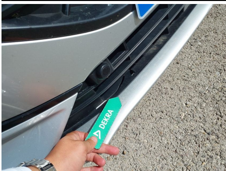
Rejilla de paragolpes / Delantero / Roto
