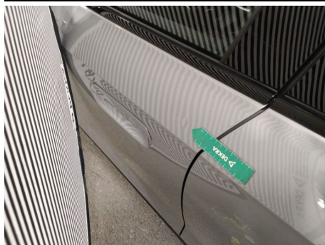
Tür / Vorne Links / Delle
