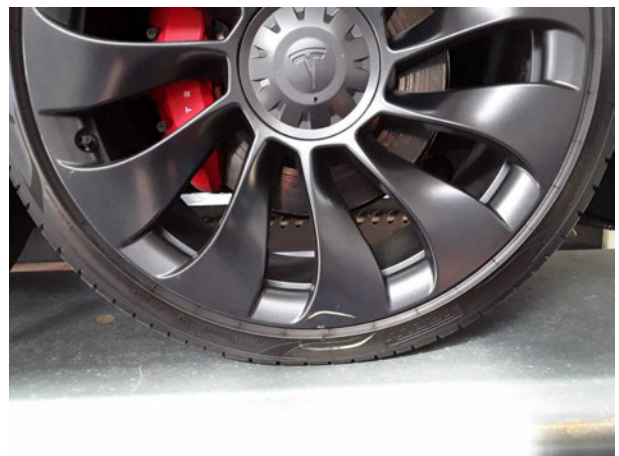
Beschädigung #3: Rad/Reifen: Reifen vorn rechts - beschädigt - erneuern
