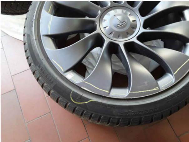
Beschädigung #2: 2.Radsatz: 1 Reifen - beschädigt - erneuern
