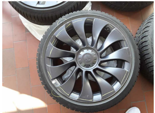
Beschädigung #8: 2.Radsatz: 2.Radsatz - verkratzt / verschürft - erneuern
