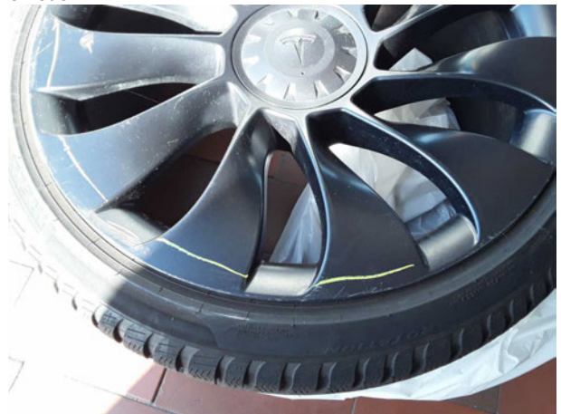
Beschädigung #8: 2.Radsatz: 2.Radsatz - verkratzt / verschürft - erneuern
