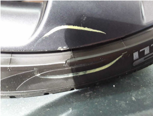
Beschädigung #3: Rad/Reifen: Reifen vorn rechts - beschädigt - erneuern
