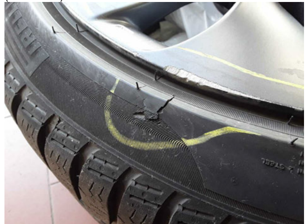
Beschädigung #2: 2.Radsatz: 1 Reifen - beschädigt - erneuern
