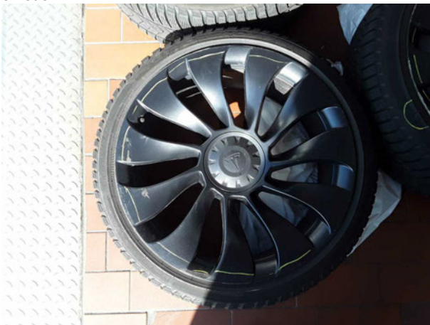
Beschädigung #8: 2.Radsatz: 2.Radsatz - verkratzt / verschürft - erneuern
