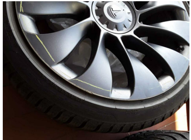
Beschädigung #8: 2.Radsatz: 2.Radsatz - verkratzt / verschürft - erneuern
