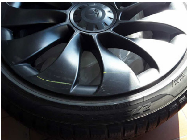
Beschädigung #8: 2.Radsatz: 2.Radsatz - verkratzt / verschürft - erneuern
