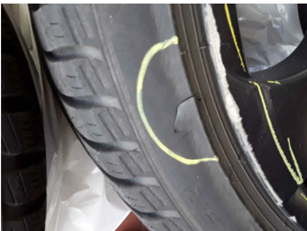
Beschädigung #2: 2.Radsatz: 1 Reifen - beschädigt - erneuern
