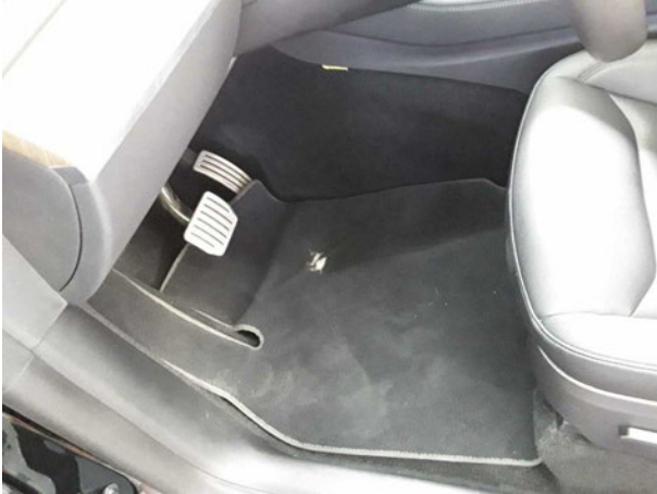
Beschädigung #1: Verkleidungen/Abdeckungen: Fußmatten (Vorne links) - verschlissen - erneuern
