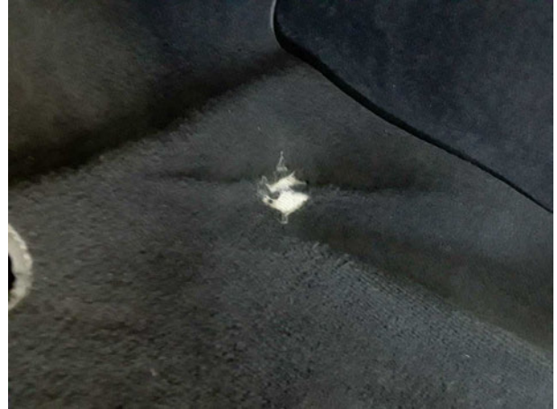
Beschädigung #1: Verkleidungen/Abdeckungen: Fußmatten (Vorne links) - verschlissen - erneuern
