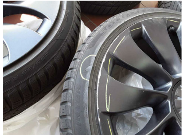
Beschädigung #8: 2.Radsatz: 2.Radsatz - verkratzt / verschürft - erneuern
