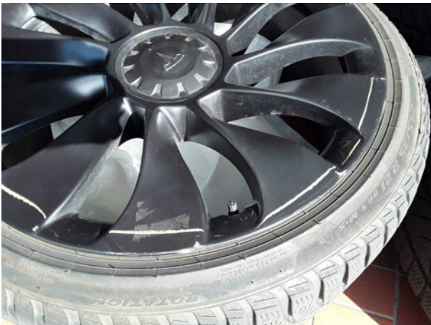
Beschädigung #8: 2.Radsatz: 2.Radsatz - verkratzt / verschürft - erneuern
