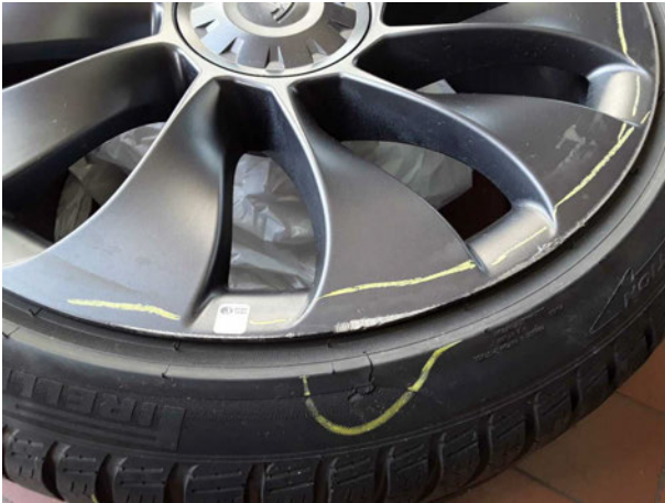
Beschädigung #8: 2.Radsatz: 2.Radsatz - verkratzt / verschürft - erneuern
