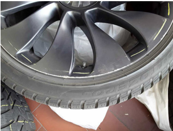
Beschädigung #8: 2.Radsatz: 2.Radsatz - verkratzt / verschürft - erneuern
