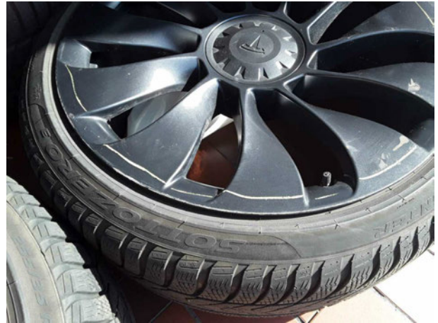
Beschädigung #8: 2.Radsatz: 2.Radsatz - verkratzt / verschürft - erneuern
