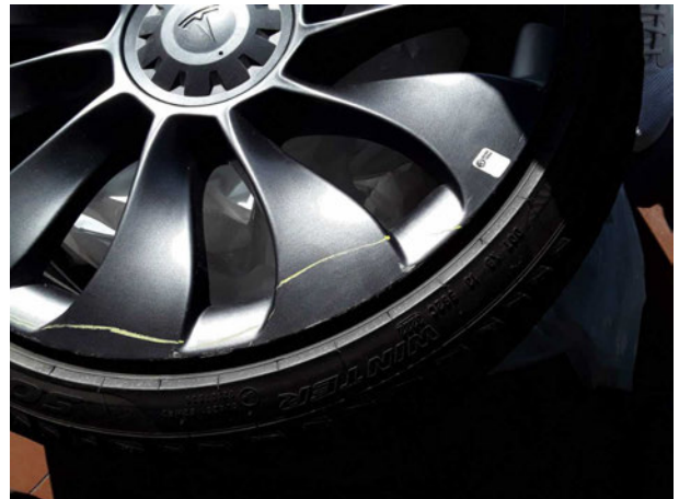
Beschädigung #8: 2.Radsatz: 2.Radsatz - verkratzt / verschürft - erneuern
