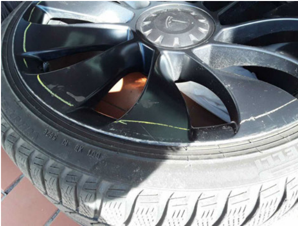
Beschädigung #8: 2.Radsatz: 2.Radsatz - verkratzt / verschürft - erneuern
