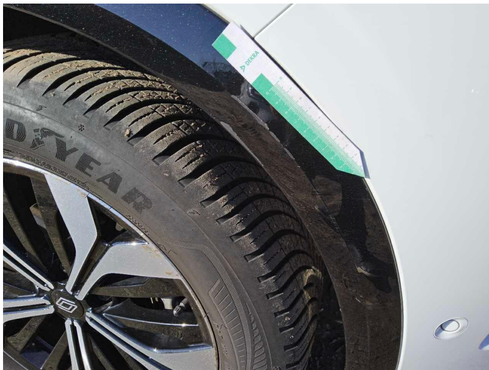
Bild 15 : Blende Radlauf vorne rechts, Kratzer
