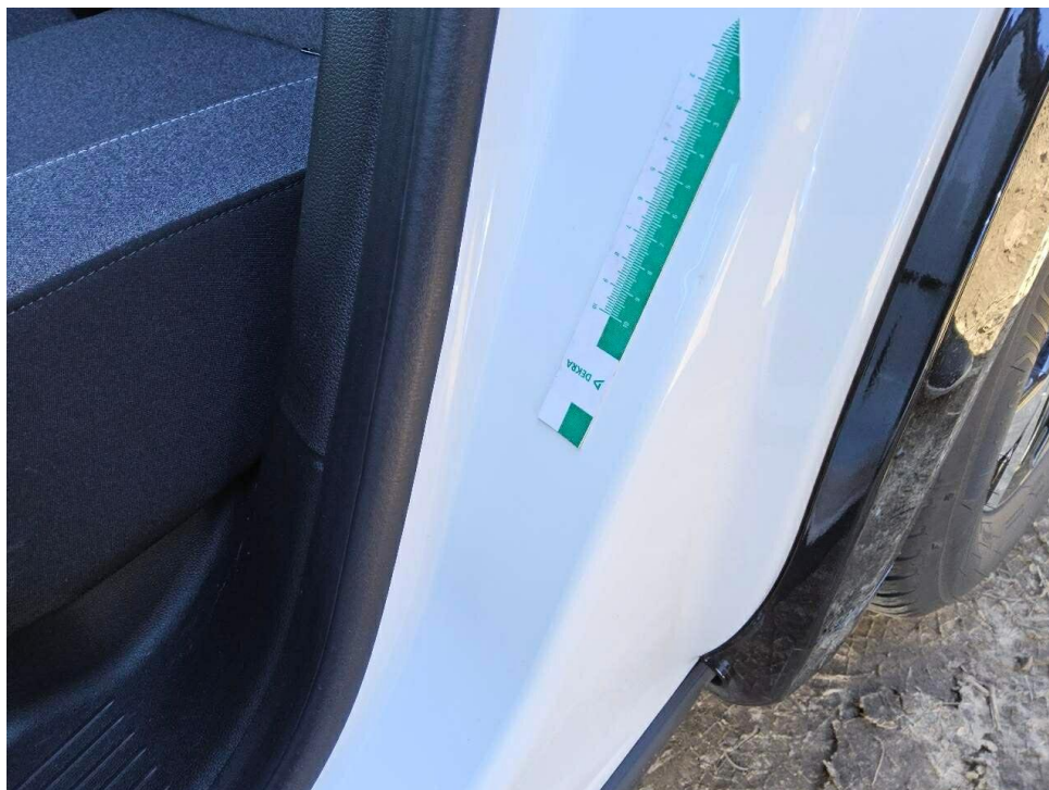
Bild 10 : Tür hinten links Einstieg, eingedellt, smart repair
