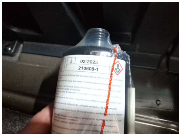
Beschädigung #1: Ausrüstung: Tirefit Füllmittel - abgelaufen - erneuern
