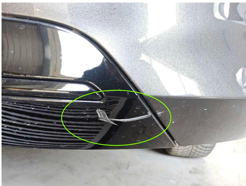
Bild 18 : Stoßfänger spoiler hinten verschrammt
