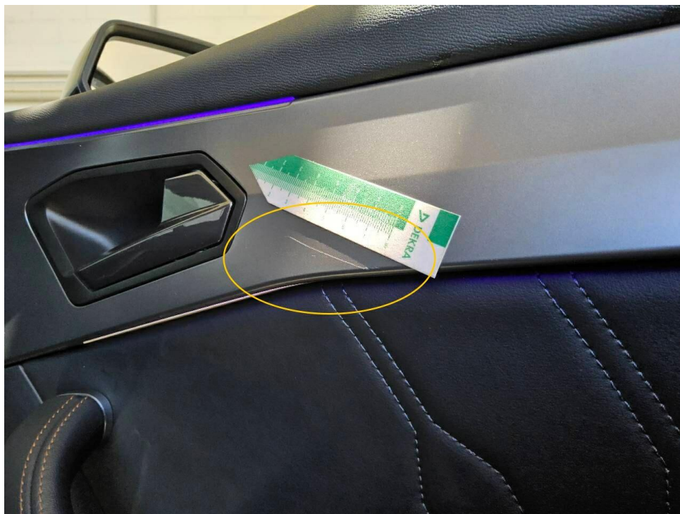
Bild 21 : Zierliche Türverkleidung vorne rechts zerkratzt
