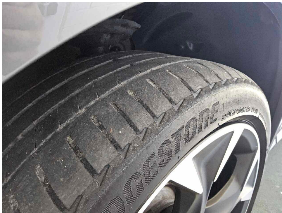
Bild 22 : Reifen vorne links abgefahren
