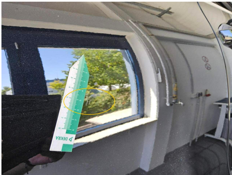
Bild 17 : Tür hinten rechts Lackierung, verschrammt, lackieren mit Lackaufbau
