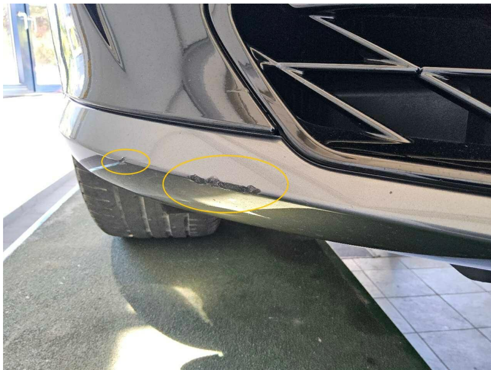
Bild 18 : Stoßfängerblende vorne verschrammt
