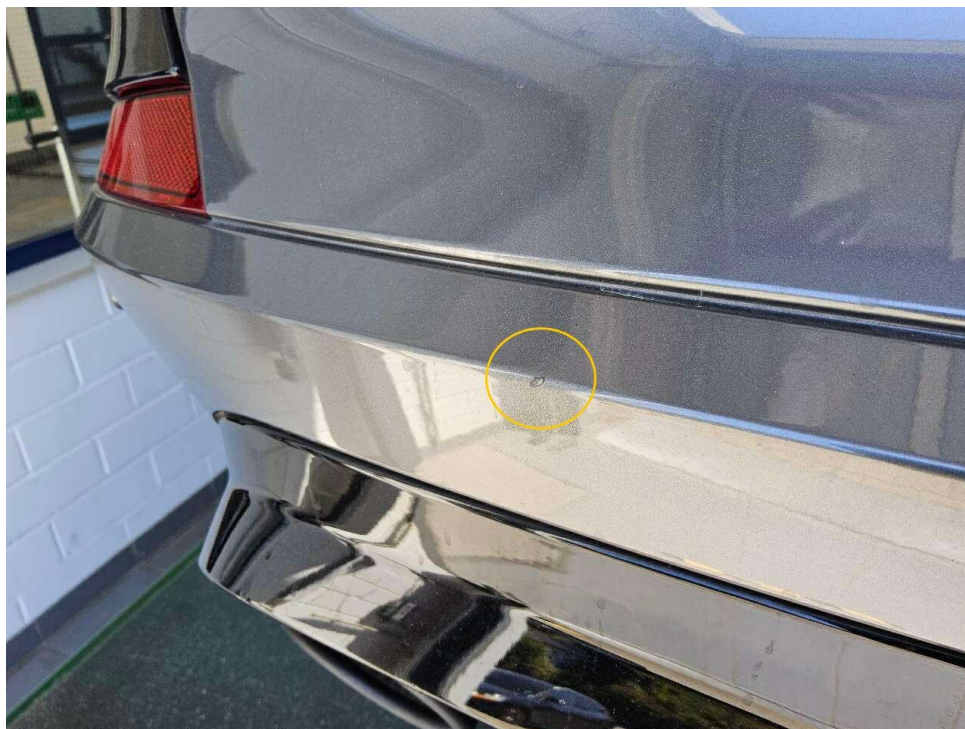
Bild 19 : Stoßfängerblende hinten verschrammt
