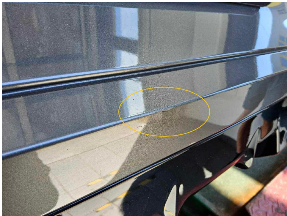
Bild 20 : Stoßfängerblende hinten verschrammt
