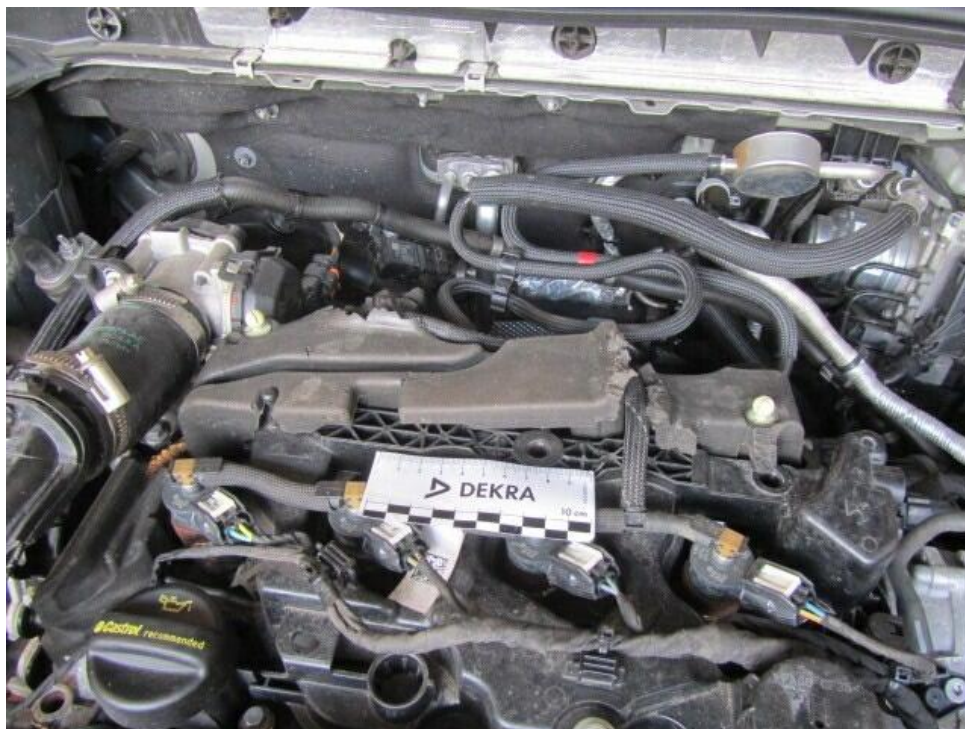
Bild 13 : Motorraum Marderschaden Teilabdeckung-Isolierung erneuern
