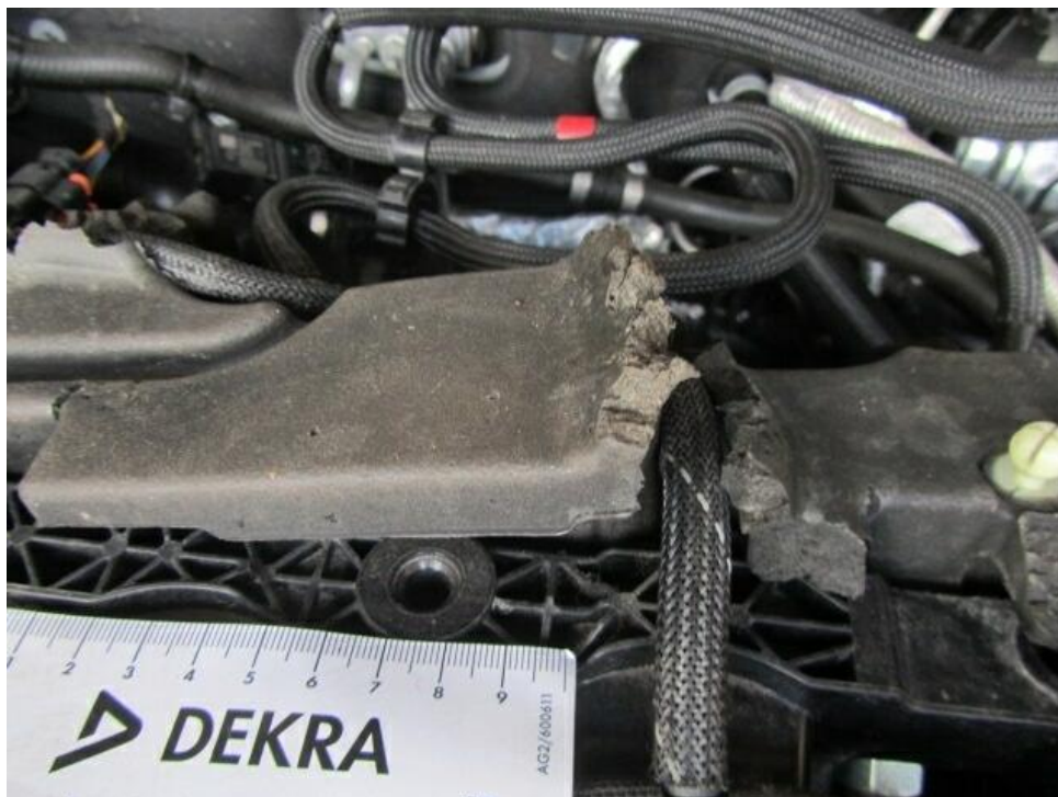
Bild 14 : Motorraum Marderschaden Teilabdeckung-Isolierung erneuern
