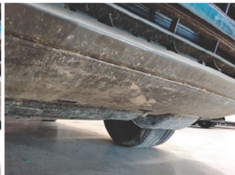
Stoßfänger unterhalb / Vorne / Kratzer
