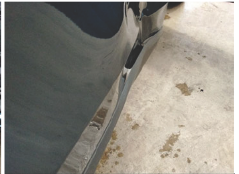
Türzürleiste / Hinten Rechts / Gebrochen
