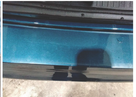
Stoßfänger oberhalb / Hinten / Kratzer
