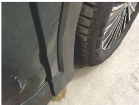
Kotflügel / Vorne Rechts / Delle
