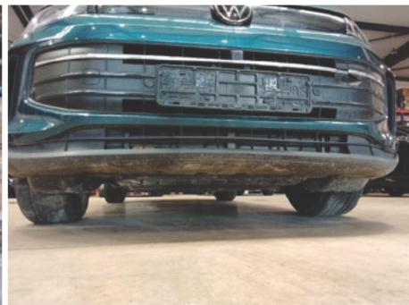
Unterfahrschutz / Vorne / Kratzer
