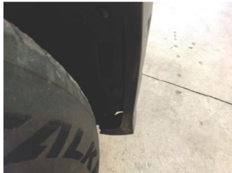
Kotflügelverbreiterung / Vorne Rechts / Gebrochen
