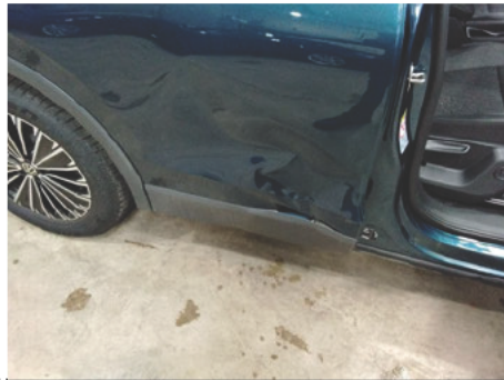
Türzürleiste / Hinten Rechts / Gebrochen
