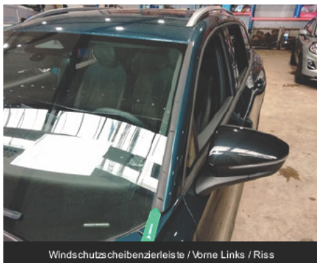
Windschutzscheibenzerleiste / Vorne Links / Riss
