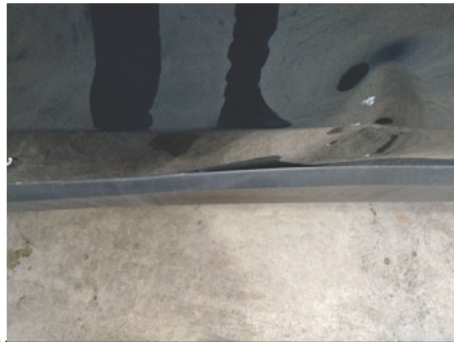
Türzürleiste / Vorne Rechts / Gebrochen
