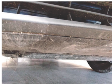
Stoßfänger unterhalb / Vorne / Kratzer
