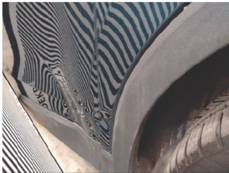
Kotflügel / Vorne Rechts / Delle
