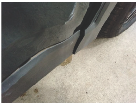
Türzürleiste / Vorne Rechts / Gebrochen
