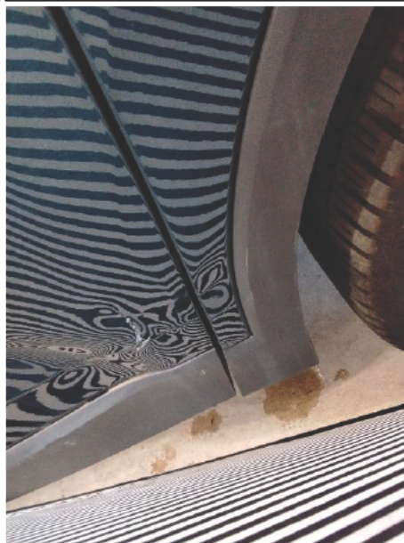
Kotflügel / Vorne Rechts / Delle
