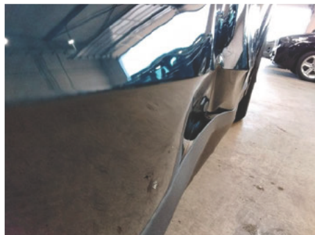
Tür / Hinten Rechts / Delle
