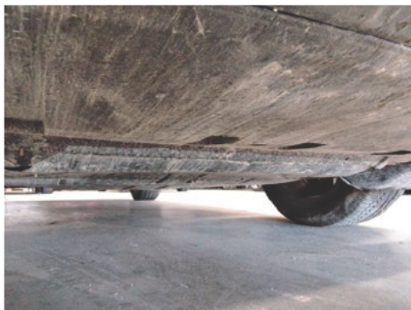
Unterfahrschutz / Vorne / Kratzer
