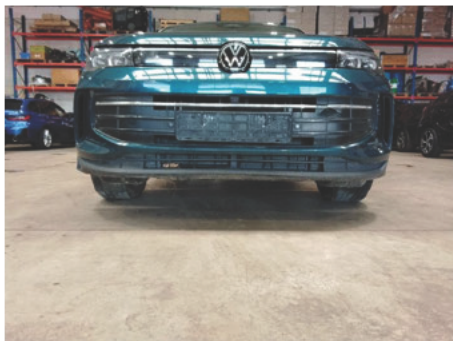
Stoßfänger unterhalb / Vorne / Kratzer
