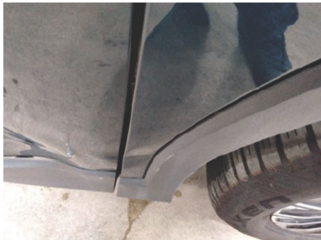
Kotflügelverbreiterung / Vorne Rechts / Gebrochen
