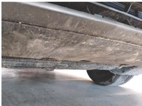
Stoßfänger unterhalb / Vorne / Kratzer
