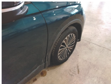
Kotflügel / Vorne Rechts / Delle
