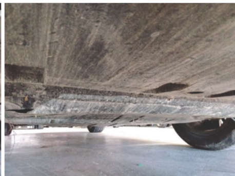
Unterfahrschutz / Vorne / Kratzer
