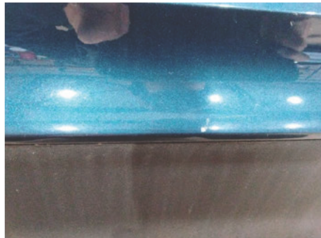
Stoßfänger oberhalb / Hinten / Kratzer
