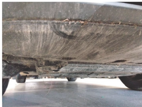
Unterfahrschutz / Vorne / Kratzer
