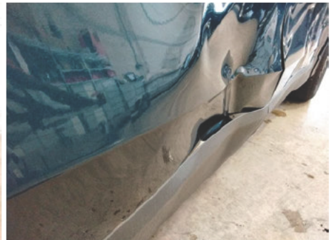
Tür / Hinten Rechts / Delle
