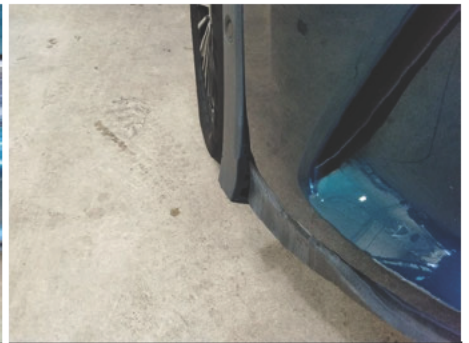
Kotflügelverbreiterung / Vorne Rechts / Gebrochen
