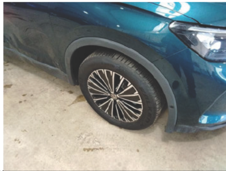
Kotflügelverbreiterung / Vorne Rechts / Gebrochen
