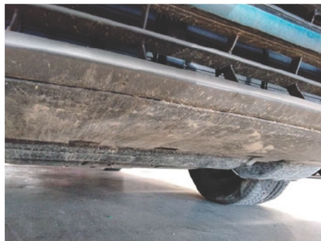
Stoßfänger unterhalb / Vorne / Kratzer
