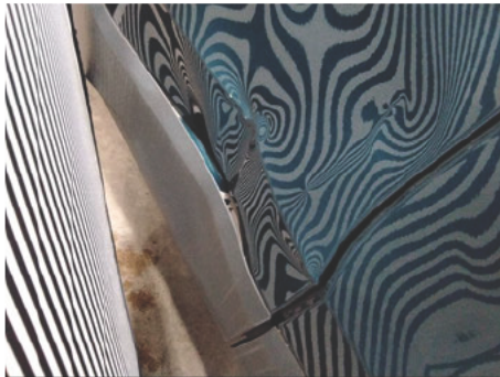
Tür / Hinten Rechts / Delle
