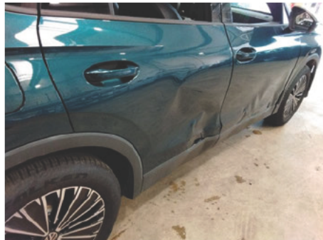
Tür / Hinten Rechts / Delle
