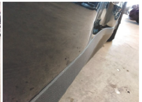
Tür / Hinten Rechts / Delle
