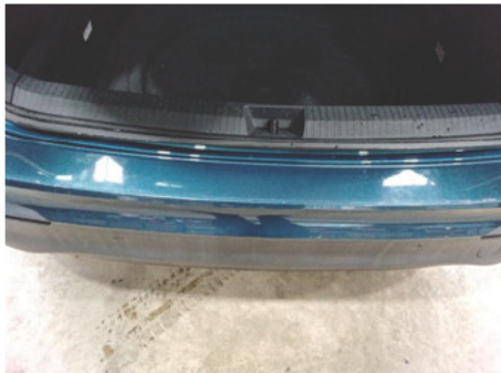
Stoßfänger oberhalb / Hinten / Kratzer
