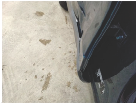
Tür / Hinten Rechts / Delle
