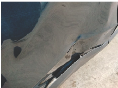
Tür / Hinten Rechts / Delle
