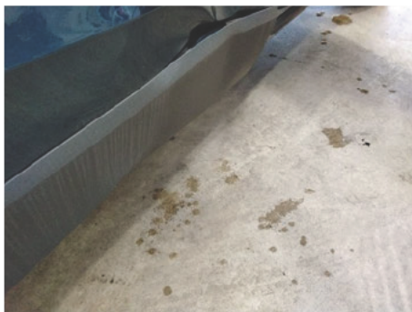
Türzürleiste / Hinten Rechts / Gebrochen
