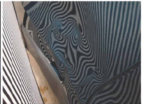
Tür / Hinten Rechts / Delle
