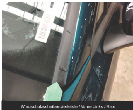
Windschutzscheibenzerleiste / Vorne Links / Riss
