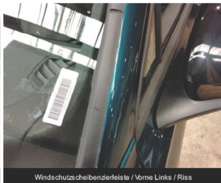
Windschutzscheibenzerleiste / Vorne Links / Riss
