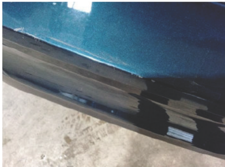
Stoßfänger oberhalb / Hinten / Kratzer
