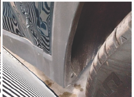
Kotflügel / Vorne Rechts / Delle
