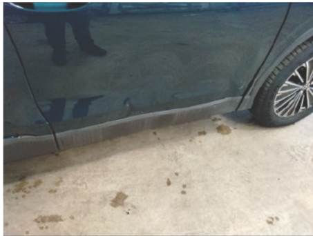
Türzürleiste / Vorne Rechts / Gebrochen
