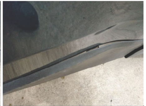
Türzürleiste / Vorne Rechts / Gebrochen
