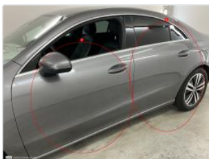
3 - Door RL - Poussière dans peinture - Bad repair
