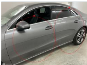
3 - Door RL - Poussière dans peinture - Bad repair
