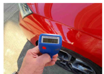
Lackstärke Kotflügel vorne links
