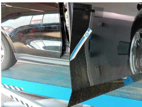
Beschädigung #2: Tür vorn rechts: Tür - Lackmangel - Smart Repair
