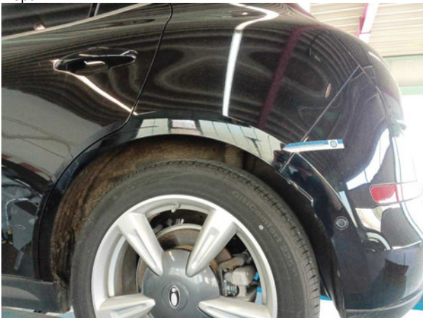
Beschädigung #5: Seitenwand links: Radlauf - Kratzer - Smart Repair
