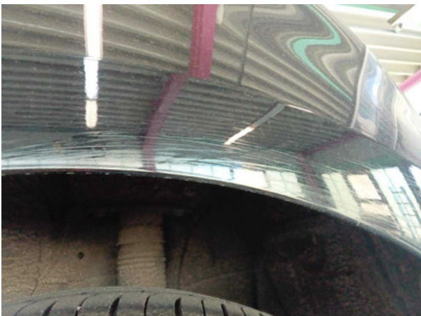
Beschädigung #5: Seitenwand links: Radlauf - Kratzer - Smart Repair
