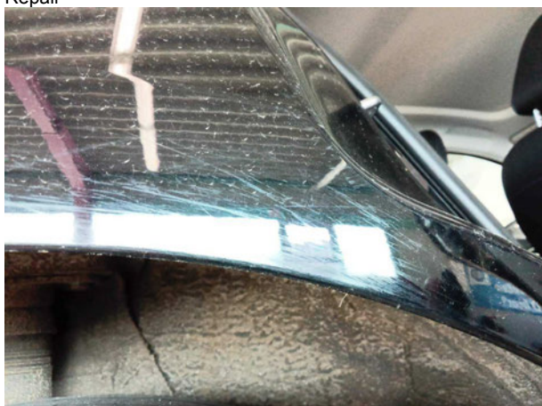
Beschädigung #6: Seitenwand rechts: Radlauf - Kratzer - Smart Repair
