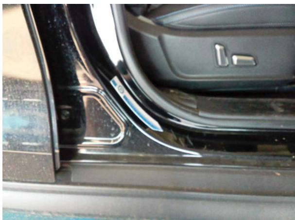
Beschädigung #3: Schweller rechts: Einstieg - Kratzer - Smart Repair
