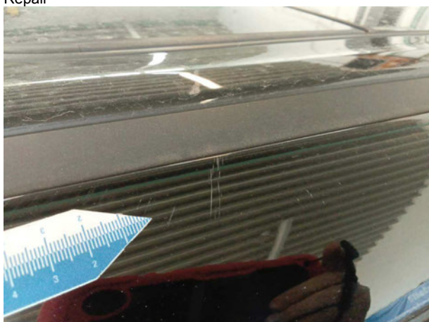
Beschädigung #7: Fahrzeugdach: Dachholm rechts - Kratzer - Smart Repair
