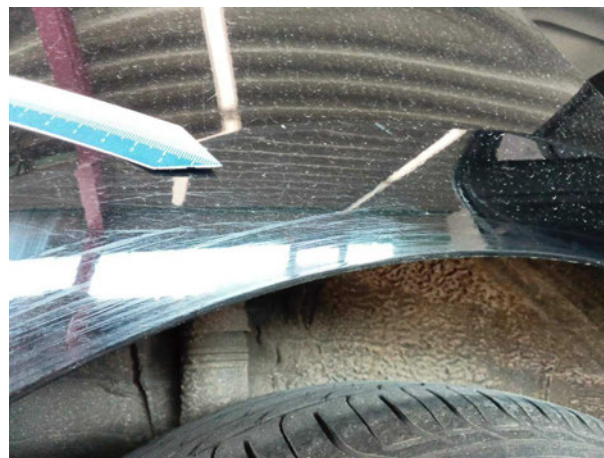
Beschädigung #6: Seitenwand rechts: Radlauf - Kratzer - Smart Repair
