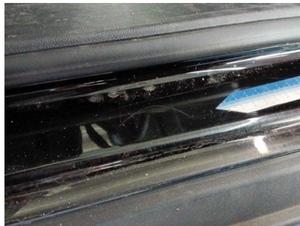
Beschädigung #1: Schweller links: Einstieg - Kratzer - Smart Repair
