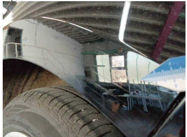
Beschädigung #5: Seitenwand links: Radlauf - Kratzer - Smart Repair
