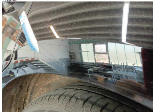
Beschädigung #5: Seitenwand links: Radlauf - Kratzer - Smart Repair
