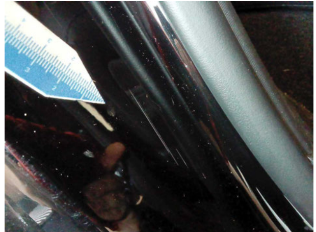
Beschädigung #4: Seitenwand rechts: Einstieg - Kratzer - Smart Repair
