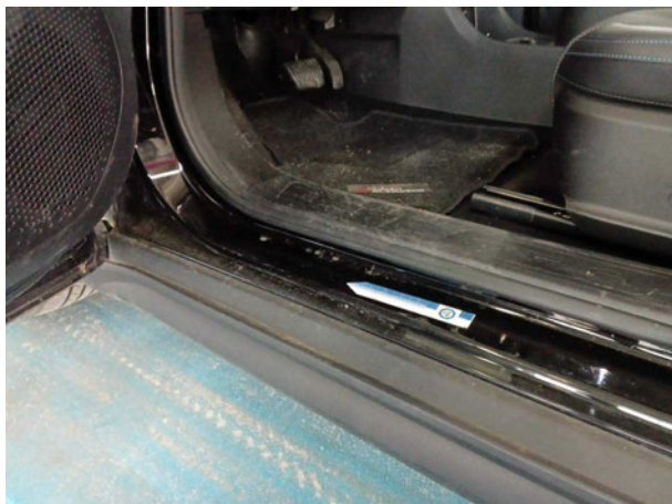
Beschädigung #1: Schweller links: Einstieg - Kratzer - Smart Repair
