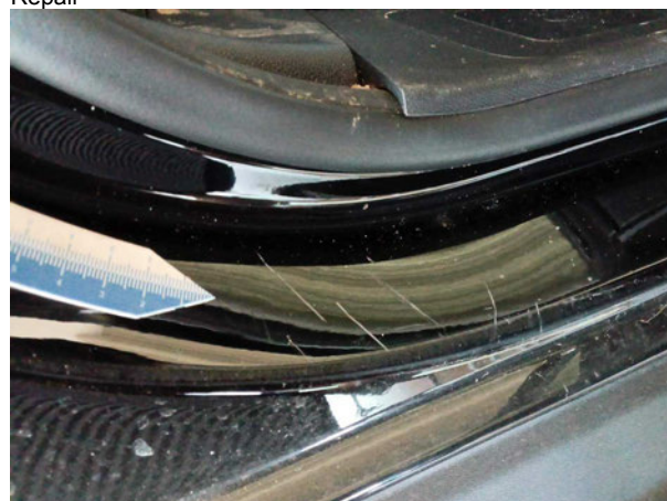
Beschädigung #3: Schweller rechts: Einstieg - Kratzer - Smart Repair
