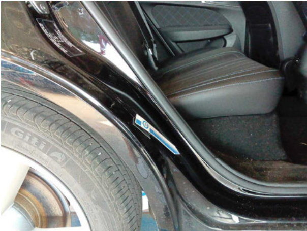
Beschädigung #4: Seitenwand rechts: Einstieg - Kratzer - Smart Repair
