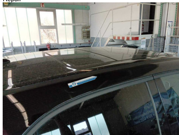
Beschädigung #7: Fahrzeugdach: Dachholm rechts - Kratzer - Smart Repair
