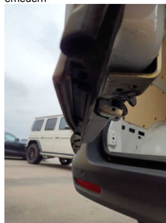
Beschädigung #16: Heckklappe/-tür: Hecktür links - verformt - erneuern
