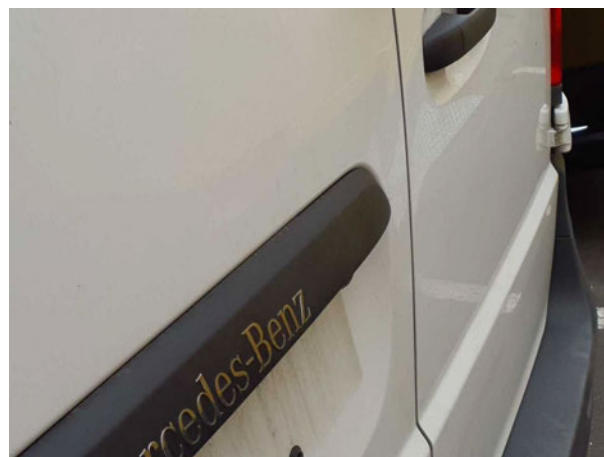
Beschädigung #16: Heckklappe/-tür: Hecktür links - verformt - erneuern
