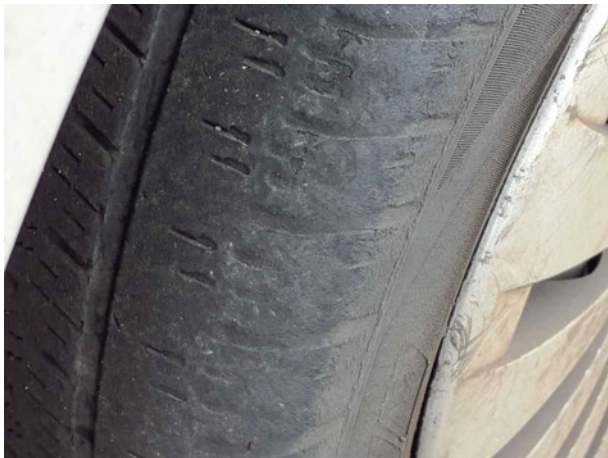
Beschädigung #9: Rad/Reifen: Reifen vorn - verschlissen - erneuern
