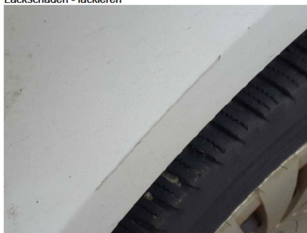
Beschädigung #8: Seitenwand links: Seitenwand - Delle / Lackschaden - lackieren
