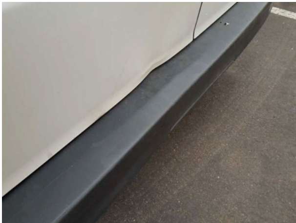
Beschädigung #11: Stossfänger hinten: Stossfänger mit Parktronic (Folgekosten können entstehen) - verformt - erneuern
