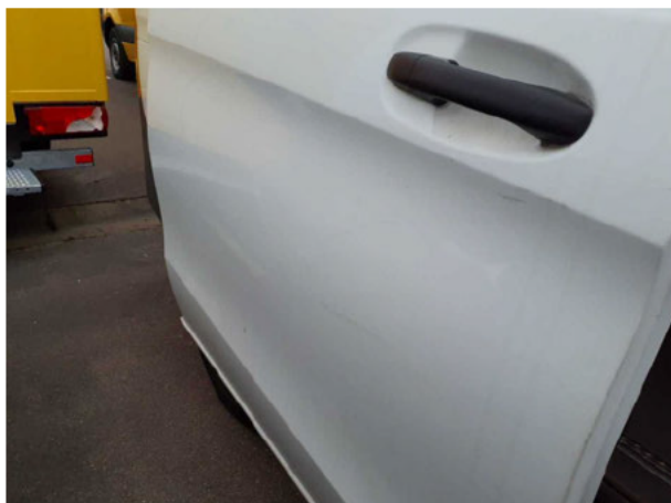
Beschädigung #6: Schiebetür rechts: Schiebetür - Delle(n) - Smart Repair
