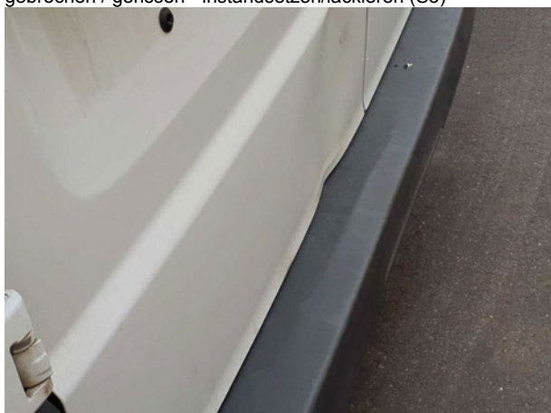
Beschädigung #16: Heckklappe/-tür: Hecktür links - verformt - erneuern
