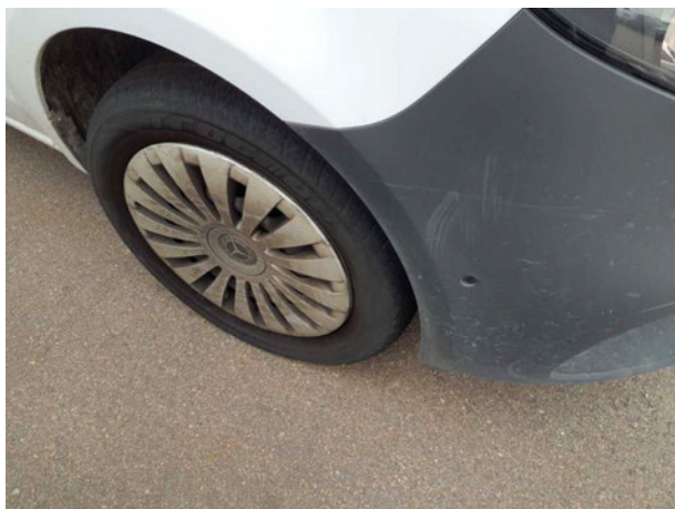
Beschädigung #1: Rad/Reifen: Raddeckel (VR) - verformt - erneuern
