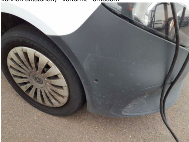
Beschädigung #13: Stossfänger vorn: Stossfänger vorn (Folgekosten können entstehen) - verformt - erneuern
