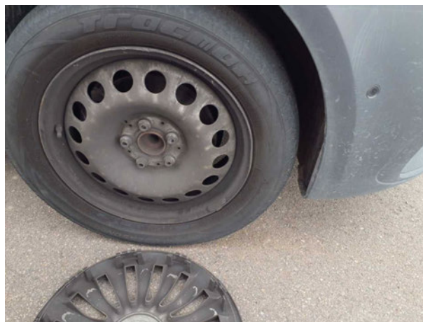
Beschädigung #3: Rad/Reifen: Felge vorn rechts (Folgekosten können entstehen) - verformt - erneuern
