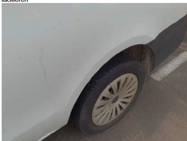
Beschädigung #8: Seitenwand links: Seitenwand - Delle / Lackschaden - lackieren
