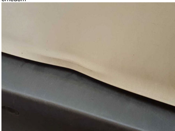
Beschädigung #16: Heckklappe/-tür: Hecktür links - verformt - erneuern
