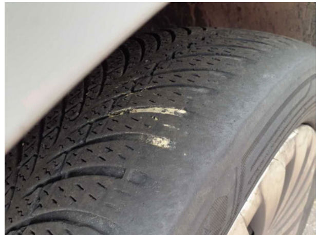
Beschädigung #9: Rad/Reifen: Reifen vorn - verschlissen - erneuern
