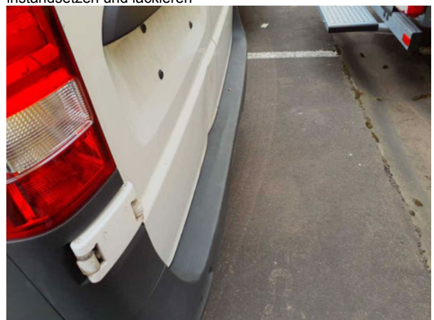
Beschädigung #11: Stossfänger hinten: Stossfänger mit Parktro... (Folgekosten können entstehen) - verformt - erneuern
