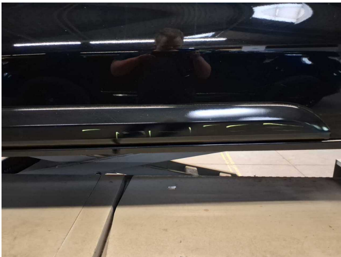
Damage 8: Sliding door - left side: Trim (Außen) - Scratch(es) - Replace
