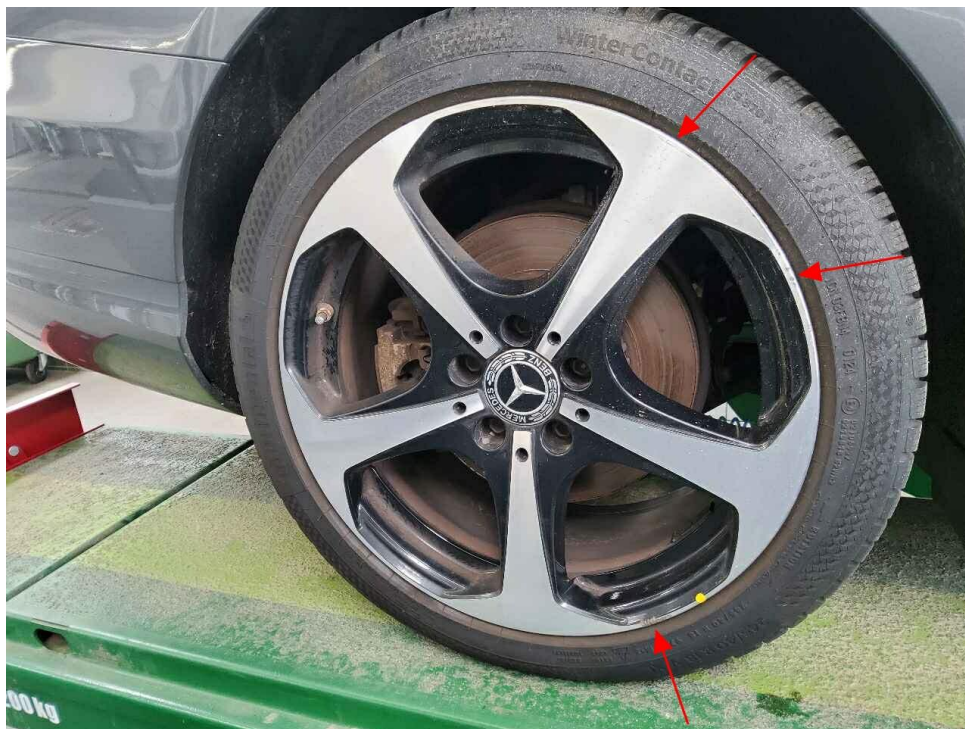
Bild 17 : Laufrad 2. Achse rechts Aluminiumfelge ( glanzgedreht ) zerkratzt mit Materialabtrag
