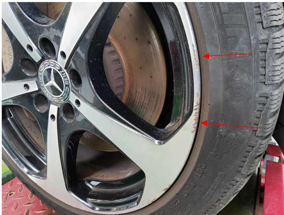
Bild 16 : Laufrad 1. Achse rechts Aluminiumfelge ( glanzgedreht ) zerkratzt mit Materialabtrag
