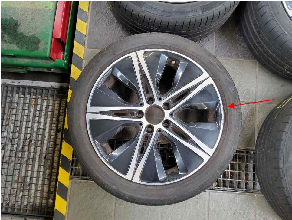
Bild 19 : Laufrad 2. Radsatz Sommer Aluminiumfelge ( glanzgedreht ) zerkratzt mit Materialabtrag
