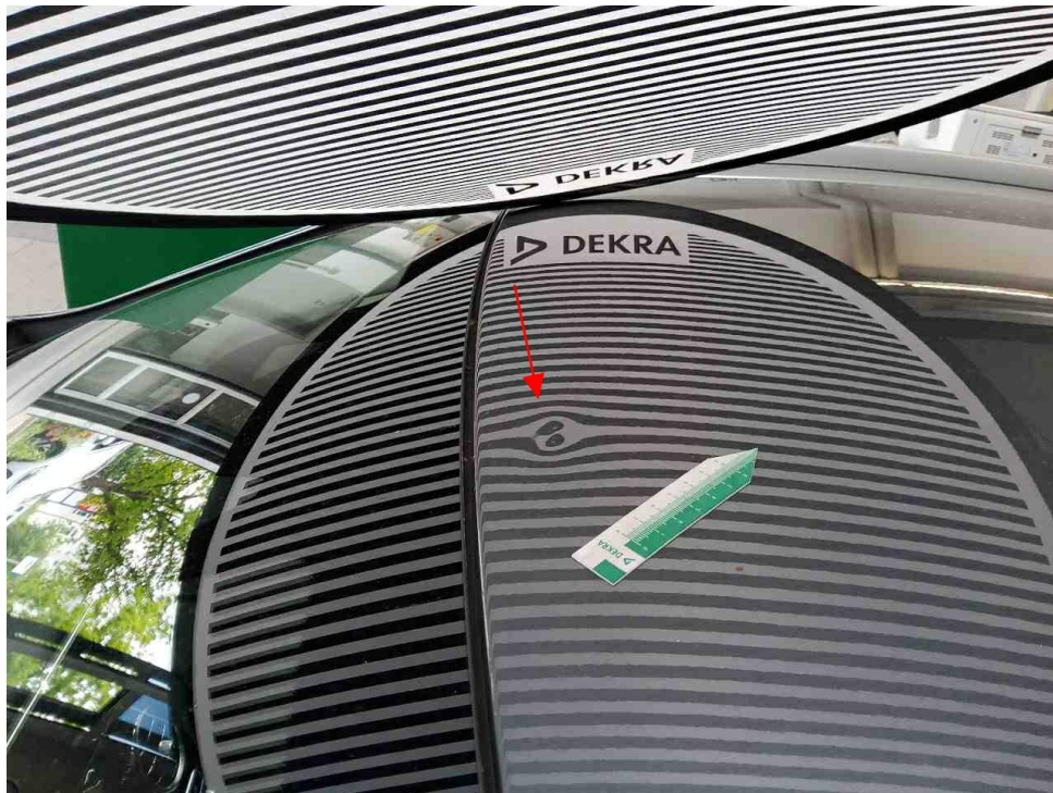
Bild 23 : Dach mehrfach eingedellt
