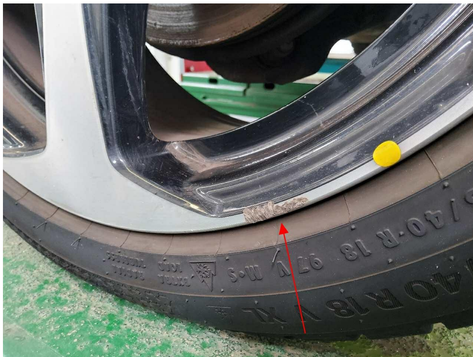
Bild 18 : Laufrad 2. Achse rechts Aluminiumfelge ( glanzgedreht ) zerkratzt mit Materialabtrag
