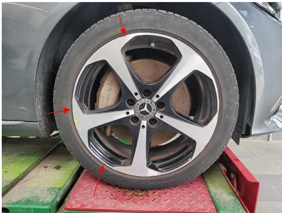
Bild 15 : Laufrad 1. Achse rechts Aluminiumfelge ( glanzgedreht ) zerkratzt mit Materialabtrag
