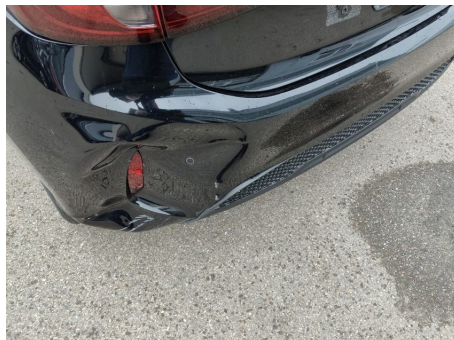
Stoßfänger / Hinten / Gebrochen
