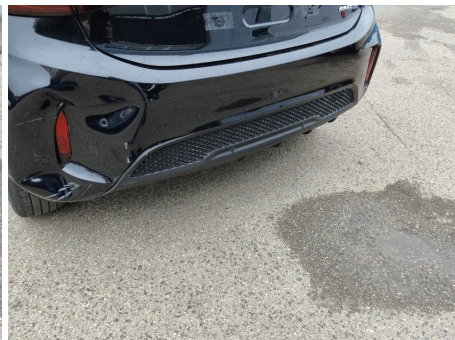
Spoiler / Hinten / Gebrochen
