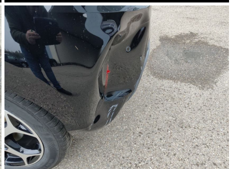
Stoßfänger / Hinten / Gebrochen
