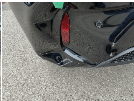
Reflektor / Hinten Links / Gebrochen
