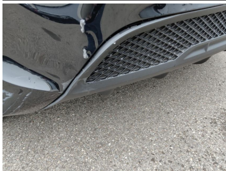
Spoiler / Hinten / Gebrochen
