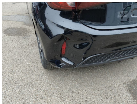
Reflektor / Hinten Links / Gebrochen
