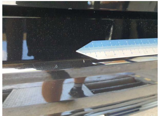
Beschädigung #2: Stoßfänger hinten: Stoßfänger hinten - Kratzer - auslegen / polieren
