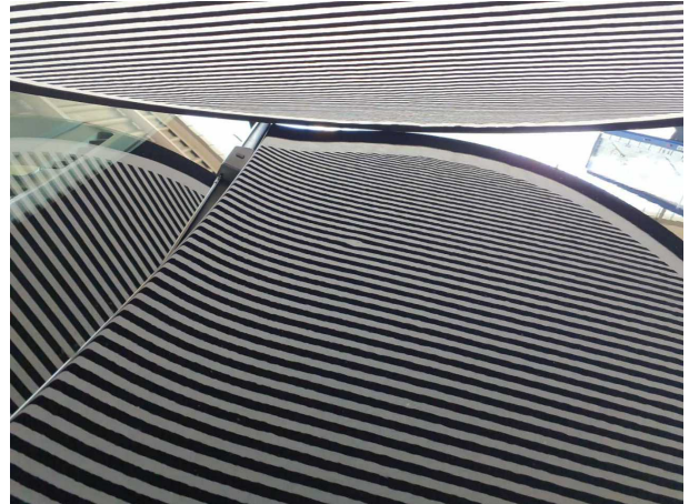
Beschädigung #1: Motorhaube: Motorhaube - Delle(n) - sanft instandsetzen
