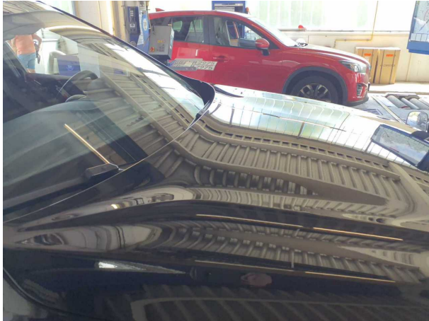
Beschädigung #1: Motorhaube: Motorhaube - Delle(n) - sanft instandsetzen
