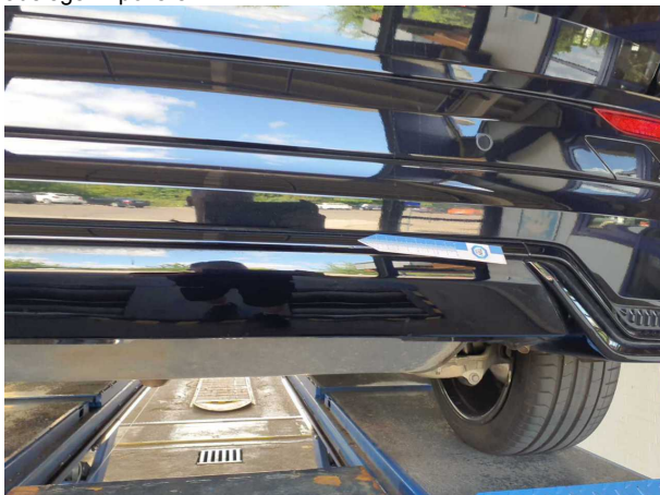
Beschädigung #3: Stoßfänger hinten: Spoiler - verkratzt / verschürft - Smart Repair
