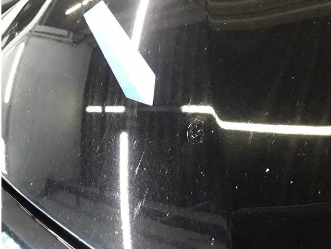
Damage 5: Bonnet: Bonnet (Vogelkot eingebrannt) - Paint defect - Paint
