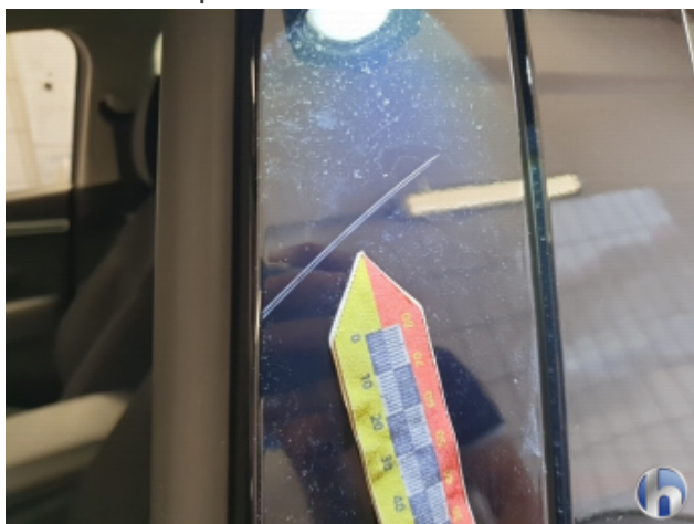
8. B-Säule Mitte - Links Beschädigt - Erneuern
