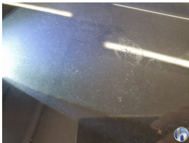
4. Dach Lackabplatzer - Lackieren
