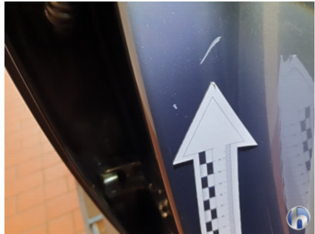
3. Türeinstieg Vorne - Rechts Kratzer - Smart Repair
