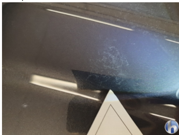
4. Dach Lackabplatzer - Lackieren
