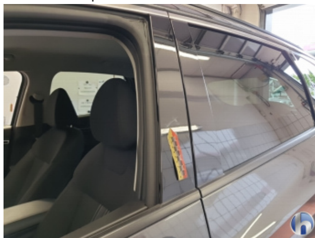
8. B-Säule Mitte - Links Beschädigt - Erneuern
