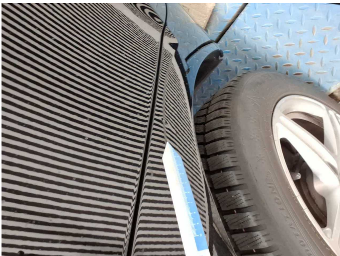
Damage 2: Side panel - rear right side: Elbow (Kante) - dent(s) - Paint
