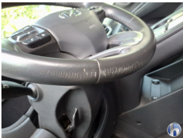
2. Lenkrad Beschädigt - Erneuern
