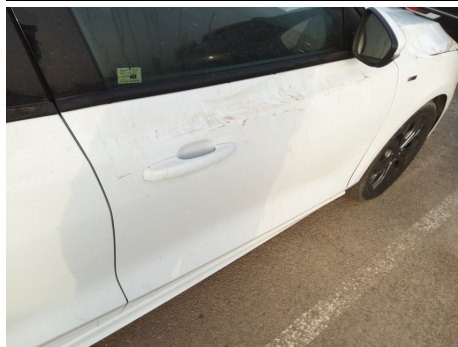
Puerta / Delantero Derecho / Abolladura
