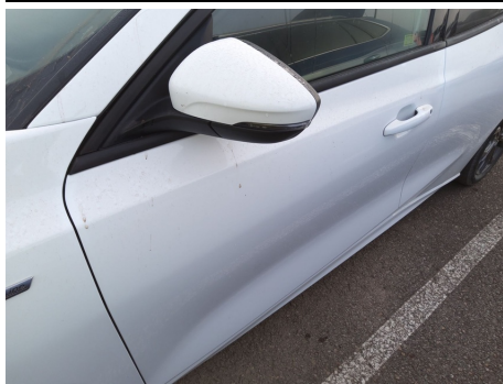
Puerta / Delantero Izquierdo / Abolladura
