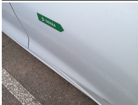
Puerta / Trasero Izquierdo / Abolladura
