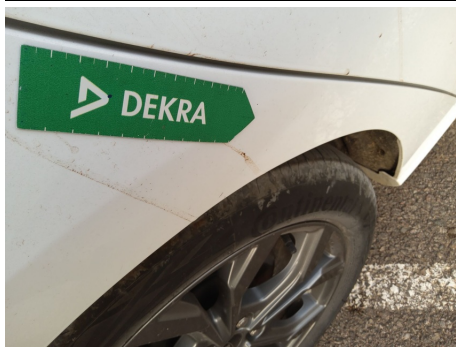
Aleta / Trasero Derecho / Abolladura
