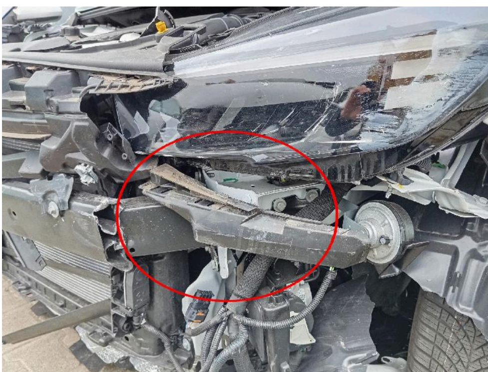
Bild: 50 Längsträger vorne links nach rechts deformiert
