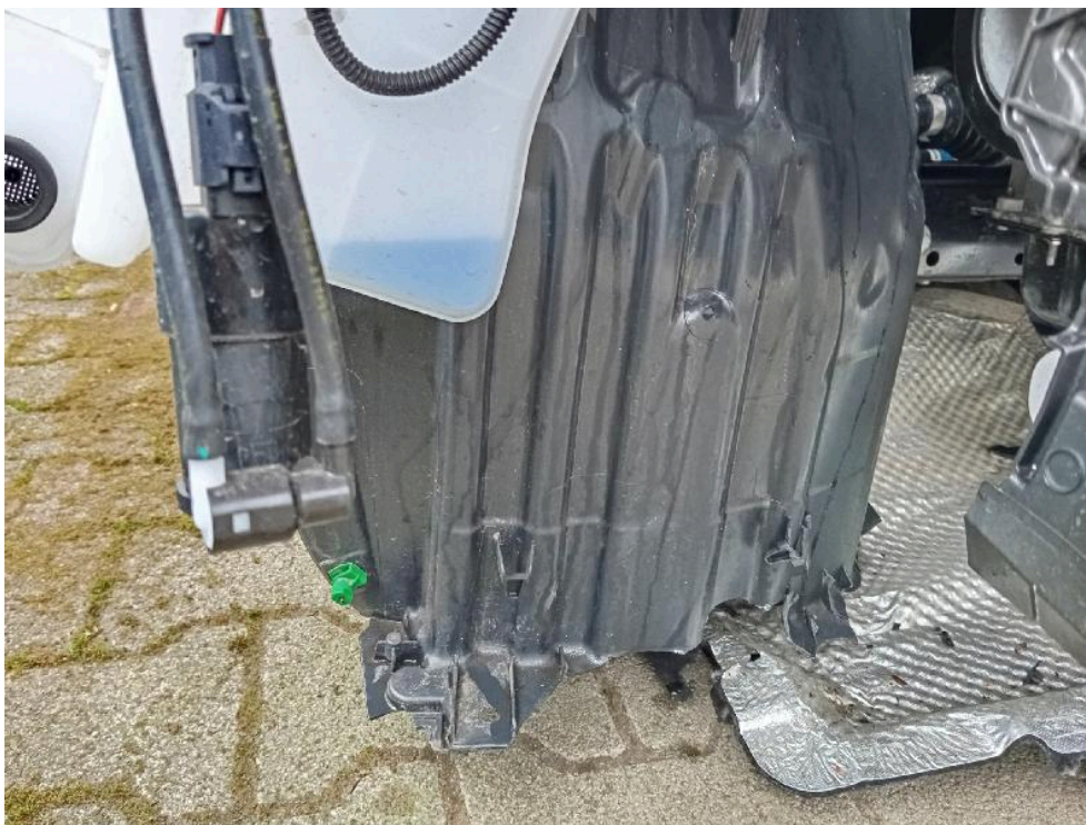
Bild: 47 Radhausverkleidung vorne links deformiert
