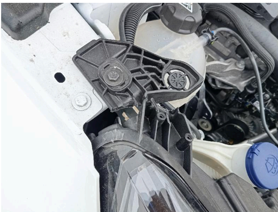
Bild: 36 Scheinwerfer rechts gebrochen
