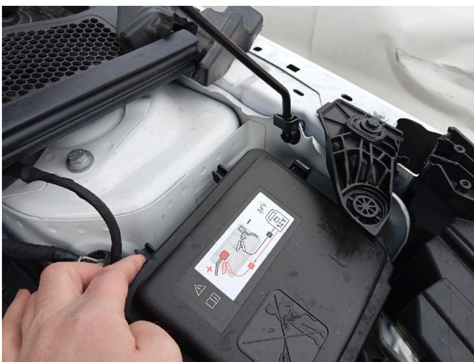
Bild: 56 Sicherungskasten Motorraum gebrochen
