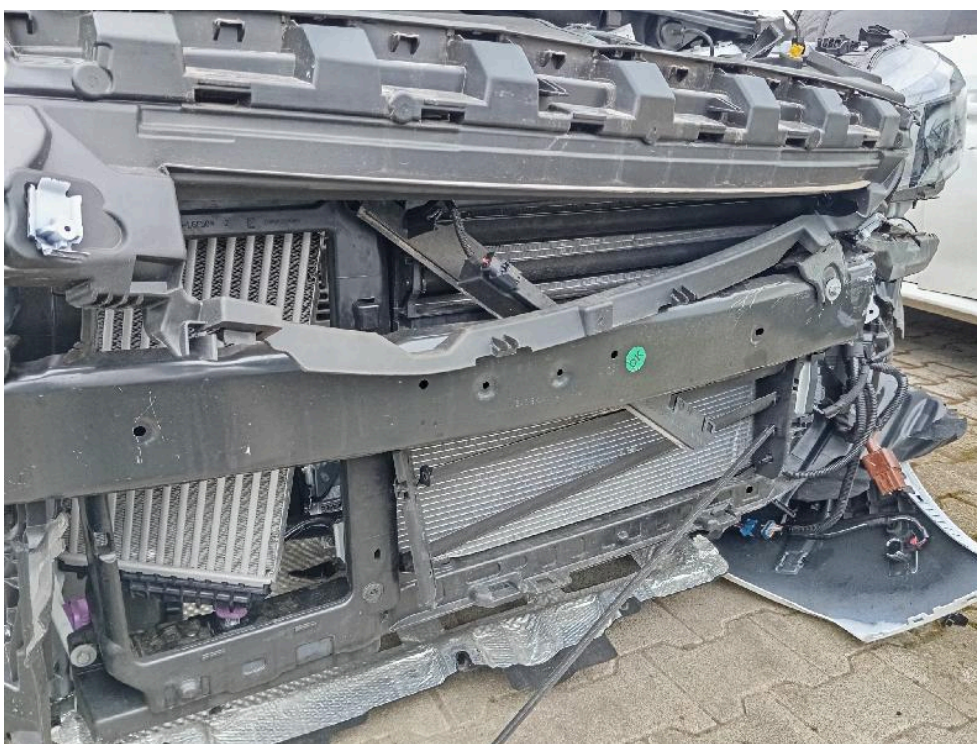
Bild: 38 Kühlerpaket Kpl. deformeirt
