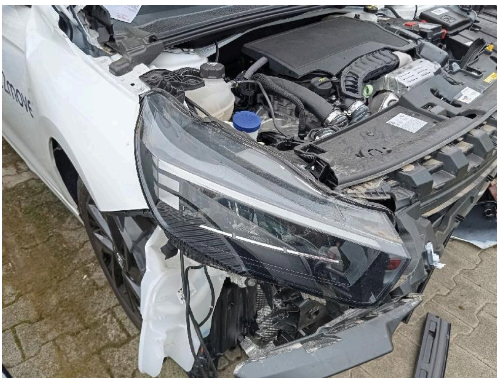
Bild: 34 Scheinwerfer rechts gebrochen
