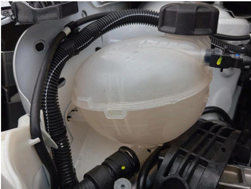
Bild: 43 Motorkühler Ausgleichsbehälter leer
