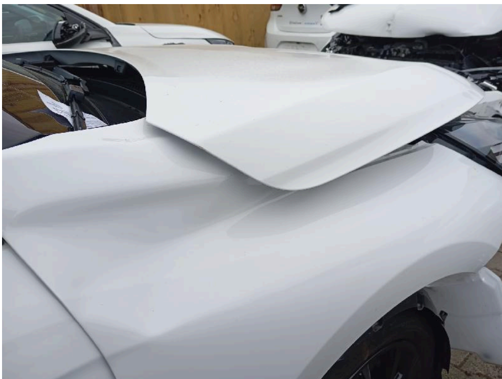
Bild: 20 Scharnier links/rechts Motorhaube deformiert
