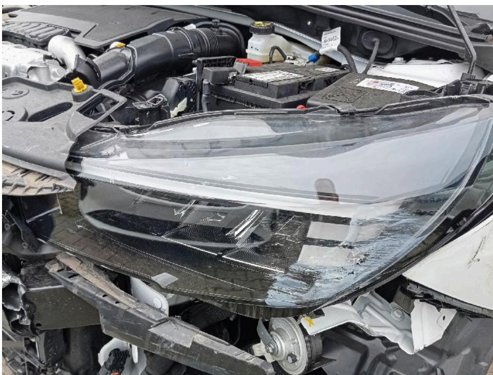
Bild: 32 Scheinwerfer links Materialabtrag
