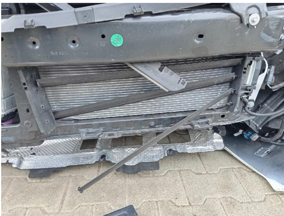
Bild: 40 Kühlerpaket Kpl. deformeirt
