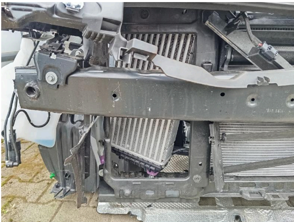
Bild: 39 Kühlerpaket Kpl. deformeirt
