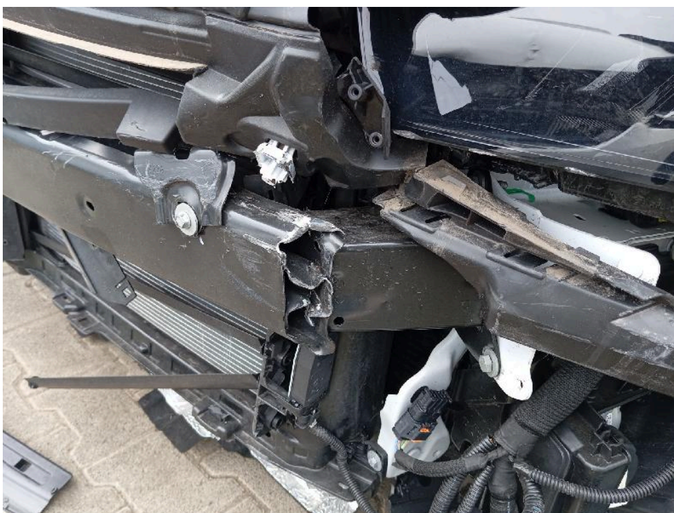
Bild: 48 Träger Stoßfänger vorne nach rechts deformiert
