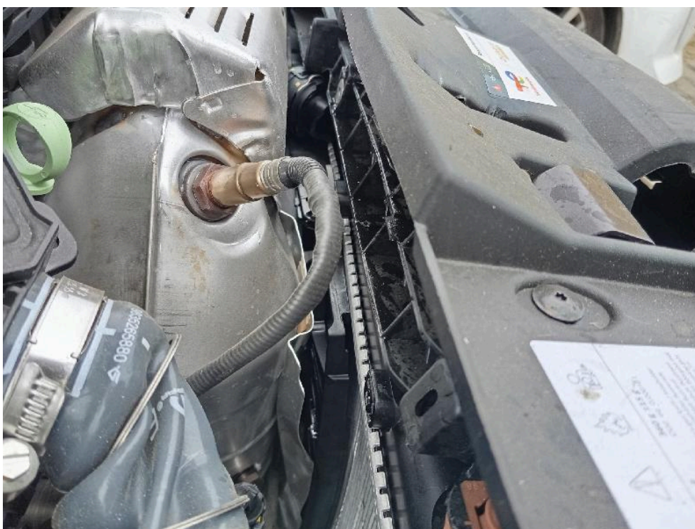
Bild: 42 Kühlerpaket Kpl. deformiert
