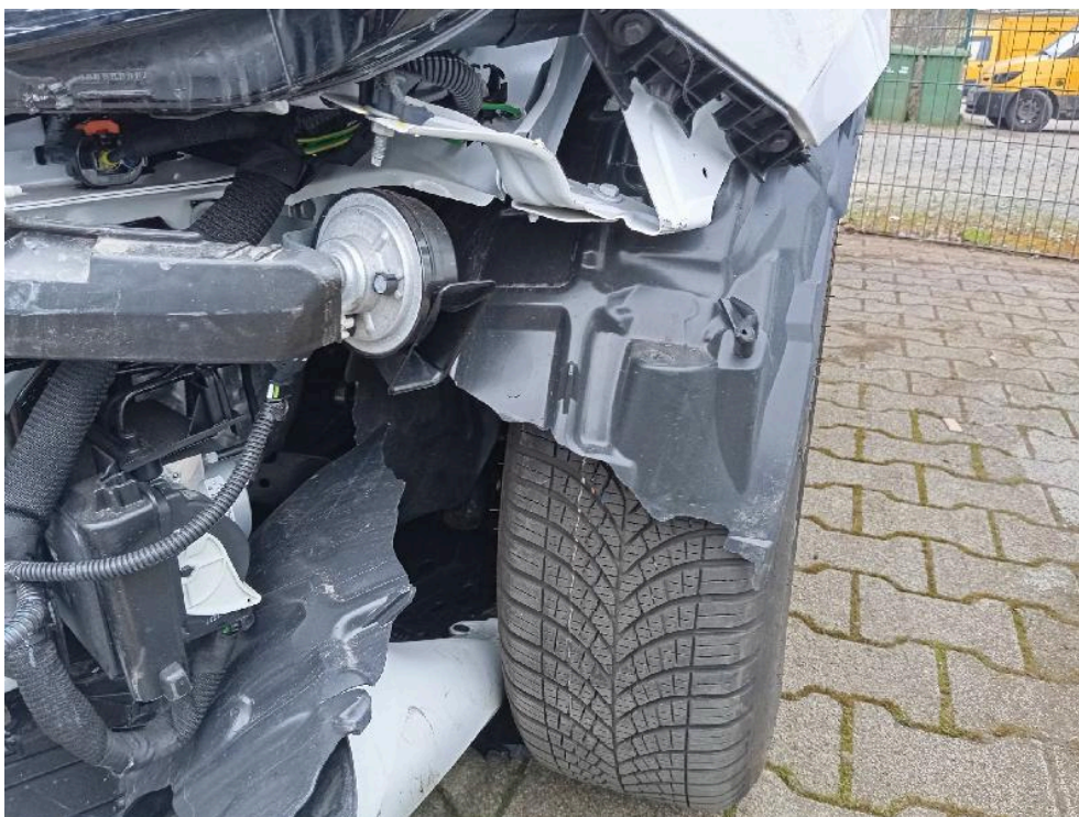
Bild: 46 Radhausverkleidung vorne links deformiert
