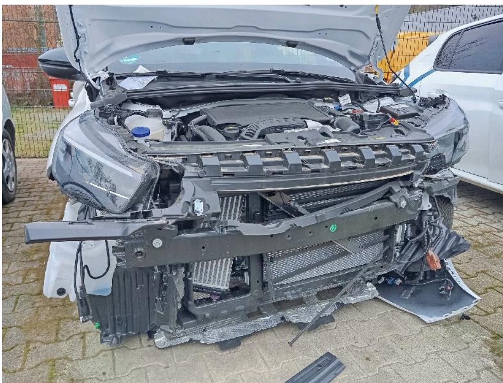
Bild: 37 Kühlerpaket Kpl. deformeirt
