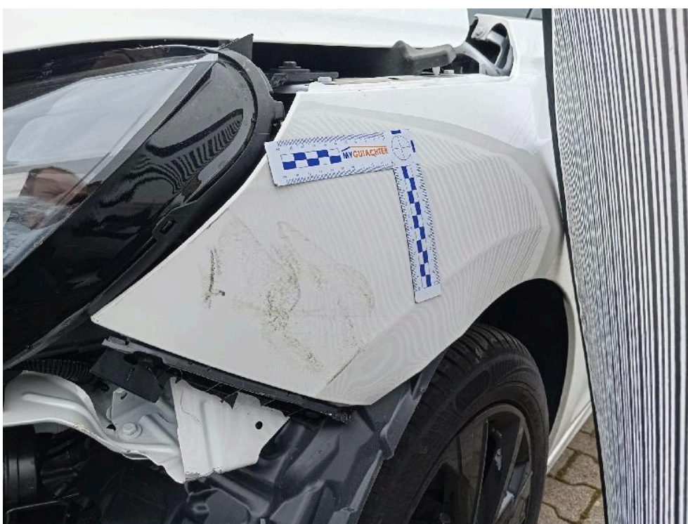
Bild: 22 Kotflügel vorne links deformiert
