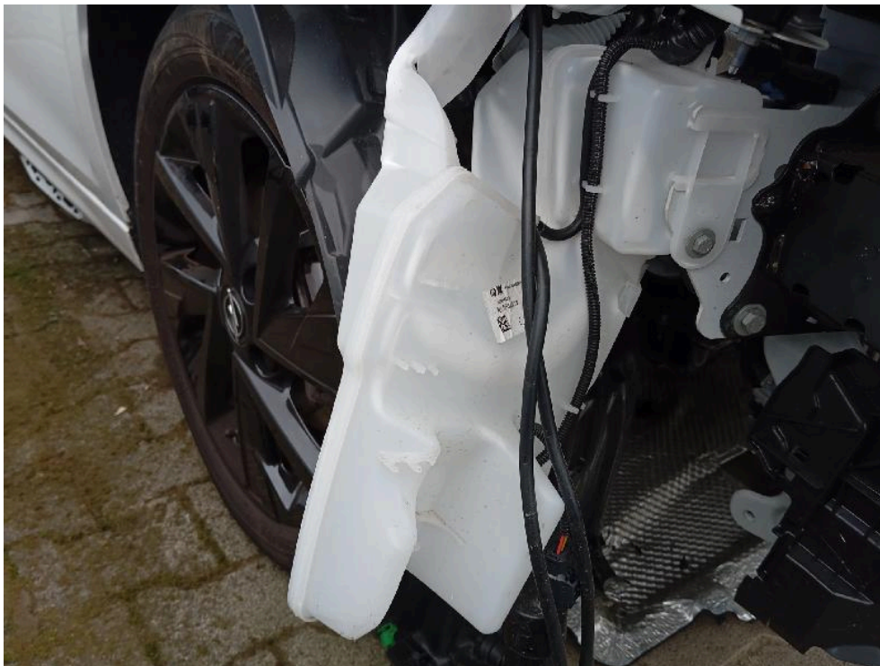
Bild: 45 Scheibenwischwasserbehälter deformiert
