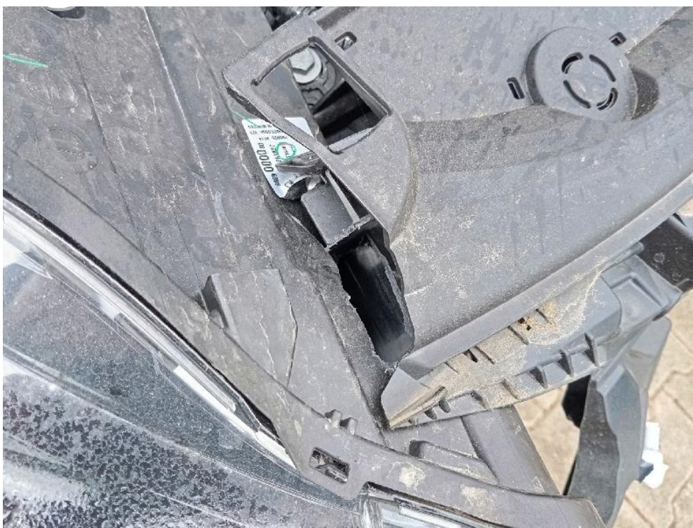
Bild: 35 Scheinwerfer rechts gebrochen
