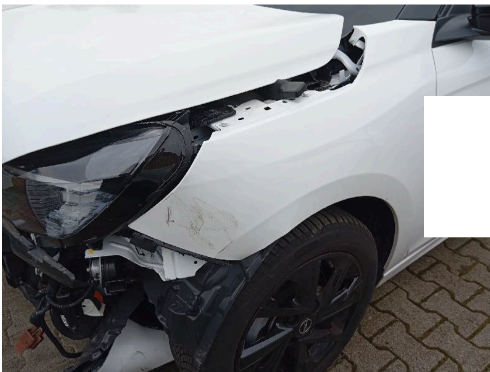
Bild: 21 Kotflügel vorne links deformiert
