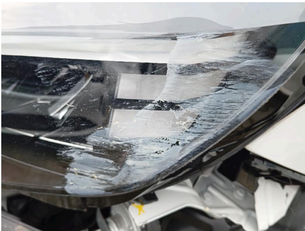
Bild: 33 Scheinwerfer links Materialabtrag
