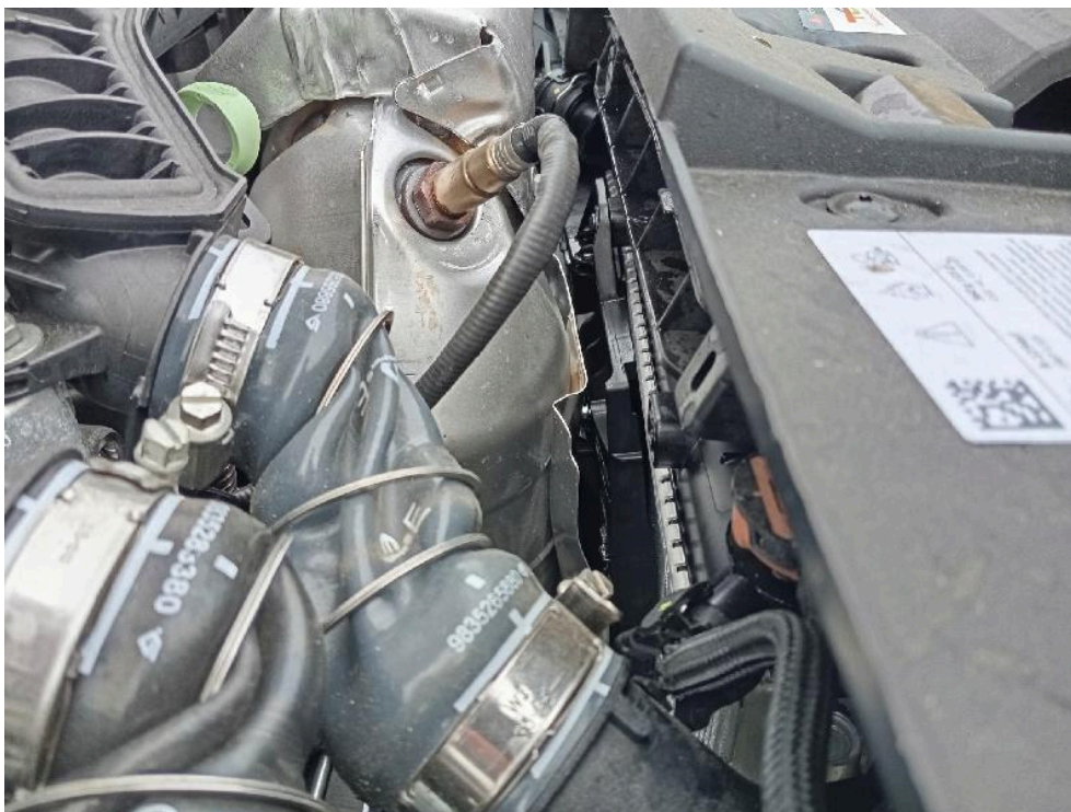
Bild: 53 Katalysator/Turbolader beaufschlagt deformiert
