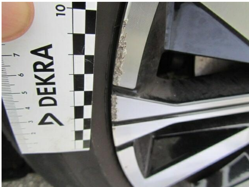
Bild 15 : Felge hinten links verschrammt glanzgedreht, Reparatur nicht zulässig
