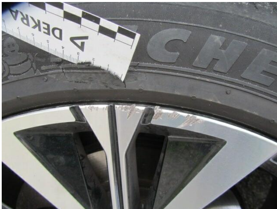
Bild 12 : Felge vorne rechts verschrommt glanzgedreht, Reparatur nicht zulässig Reifenflanke vorne rechts eingeschnitten, Gewebe sichtbar
