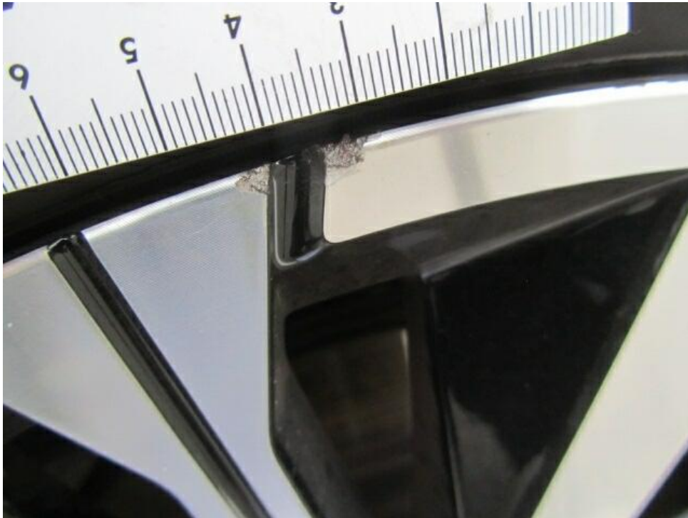
Bild 16 : Felge hinten links verschrammt glanzgedreht, Reparatur nicht zulässig
