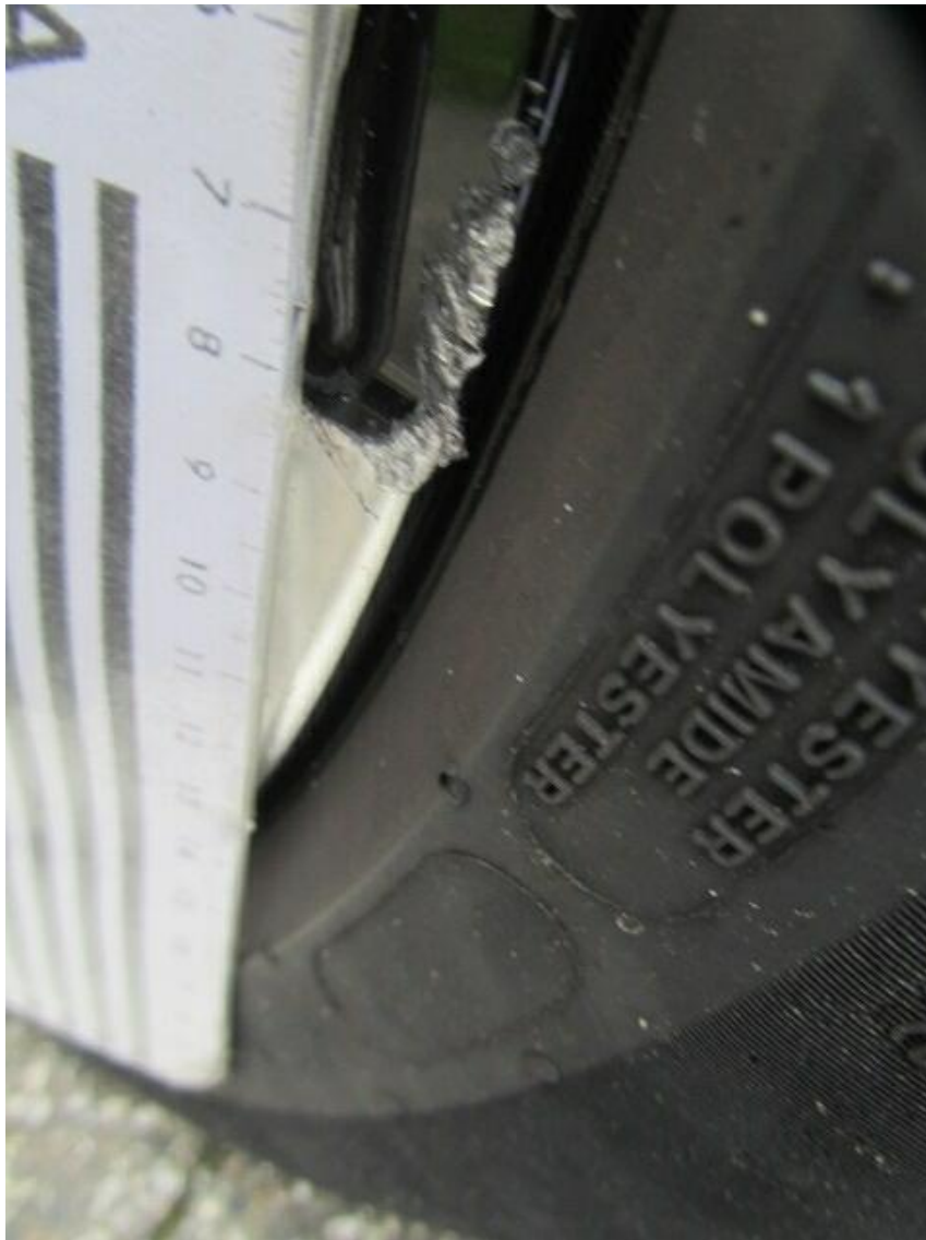
Bild 13 : Felge vorne rechts verschrammt glanzgedreht, Reparatur nicht zulässig
