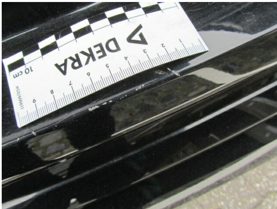
Bild 14 : Stoßfänger hinten Lackierung, verschrammt, smart repair
