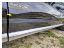
Door trim FR, Scratch(es), Paint
