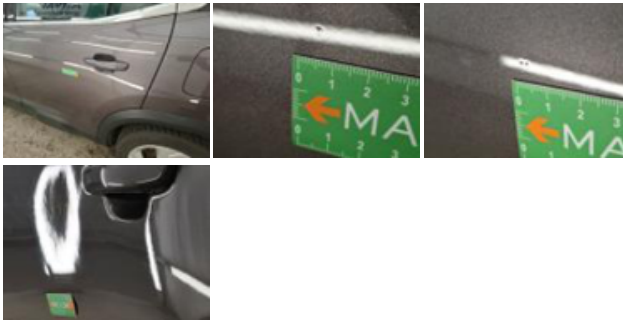
Aile ARG, Mauvaise réparation, Peindre
