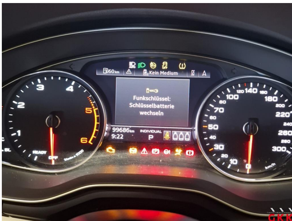
Bild 14 Hauptschlüssel, Batterie, entladen, ersetzen
