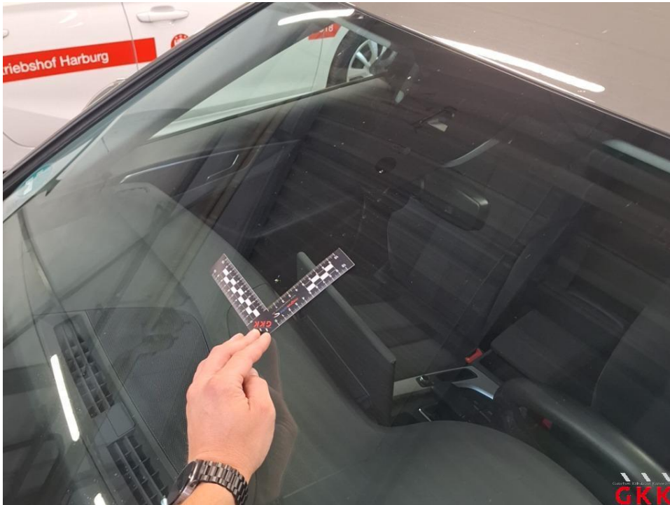
Bild 15 Frontscheibe, mit Regensensor und Frontkamera, Steinschlag mit Rissbildung, instand setzen
