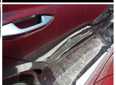
Puerta / Trasero Derecho / Abolladura
