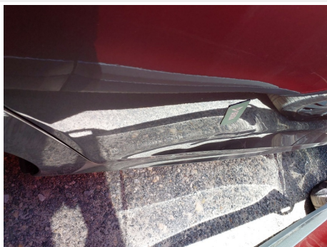
Puerta / Trasero Derecho / Abolladura
