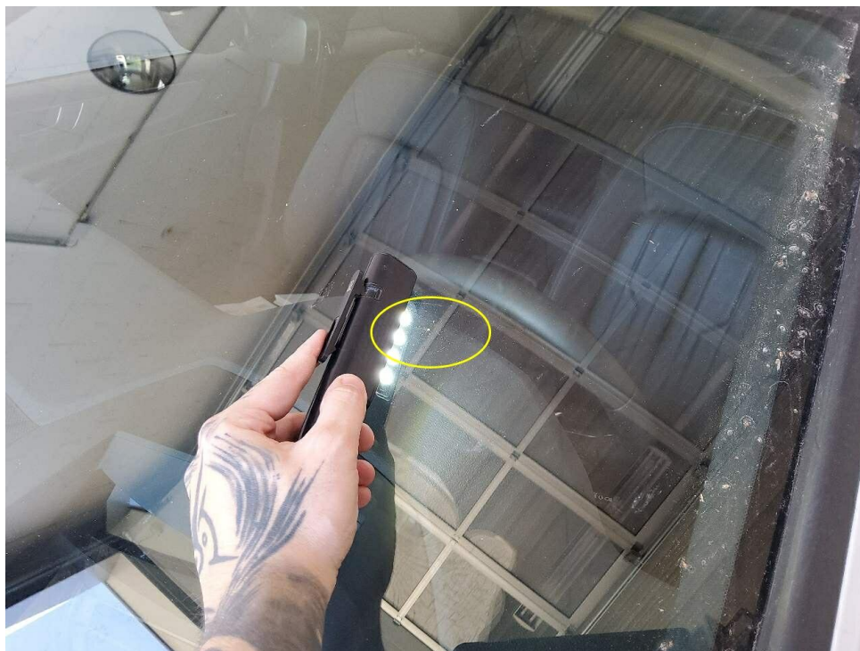
Bild 26 : Windschutzscheibe Steinschlag mit Rissbildung
