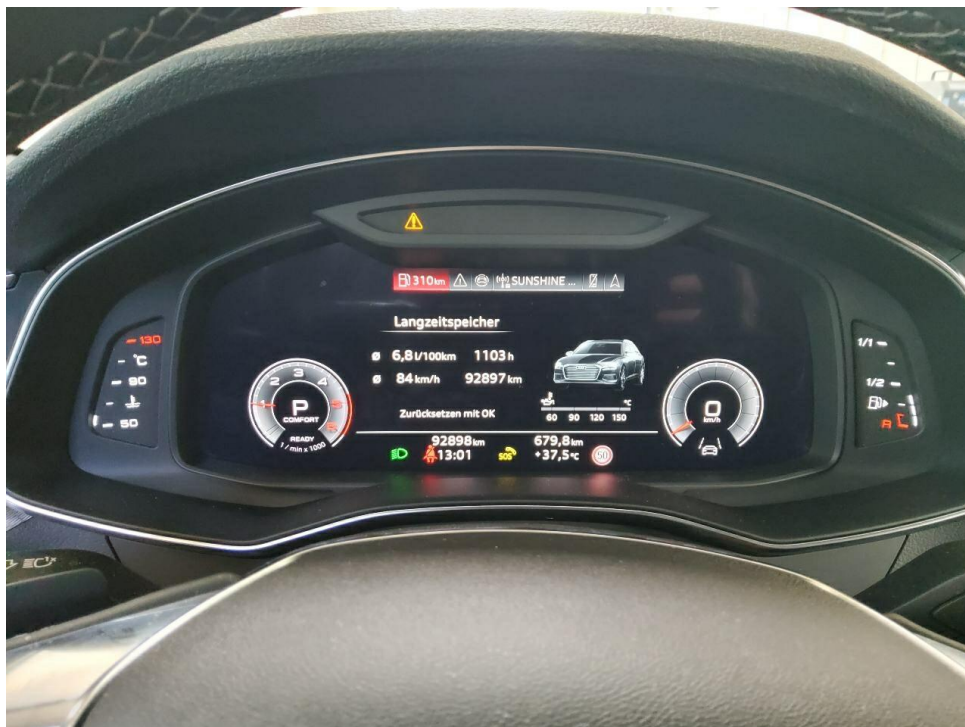
Bild 6 : Kombiinstrument (betriebsbereit) mit Km-Stand
