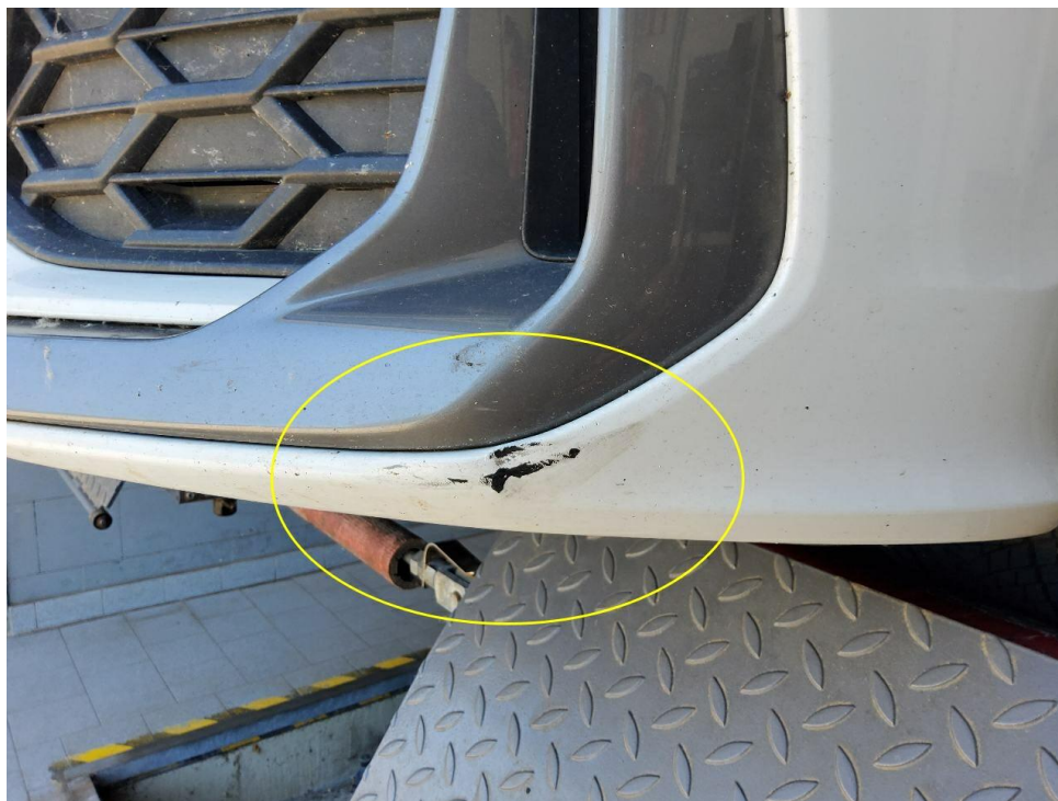
Bild 20 : Frontstoßstange linksseitig verschrammt
