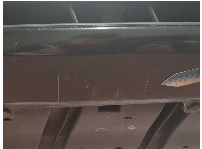
Damage 8: Front bumper: Front bumper (Oben Lack löst sich + Unten verschürft) - Scratched - Paint
